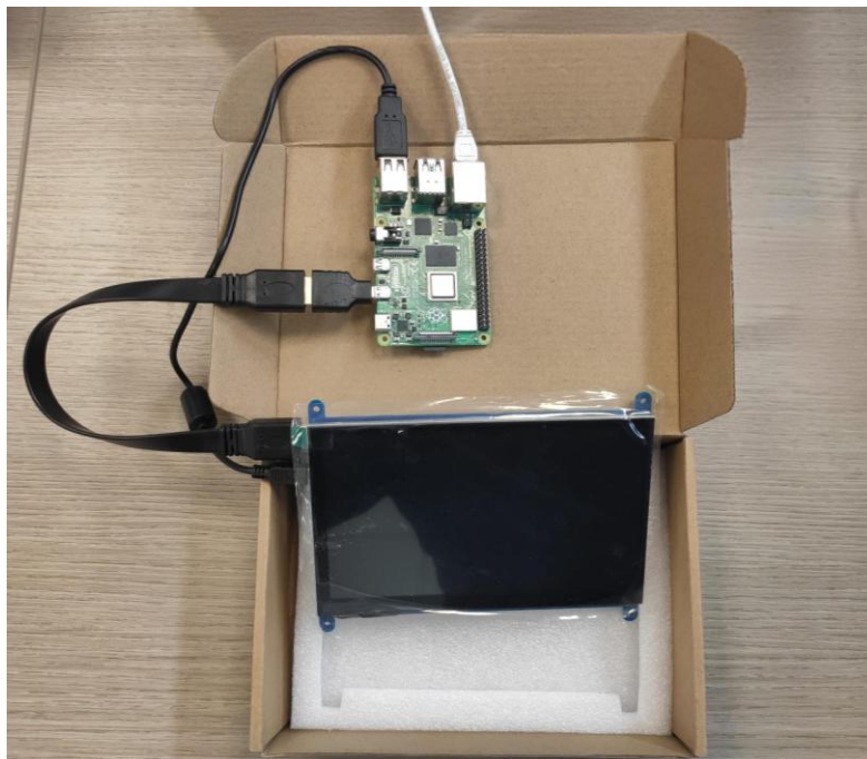
Figura 6.10: Collegamento del display touchscreen
