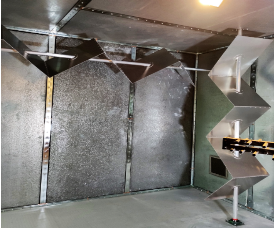
Immagine 6: Esempio di due Stirrer "Z Folder", uno lungo l'asse verticale ed uno lungo l'asse orizzontale.
