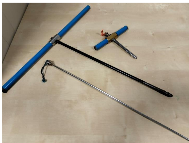
Figura 2.2.2.1 Trivelle di Pressler di lunghezza utile 40 e 15 cm.
