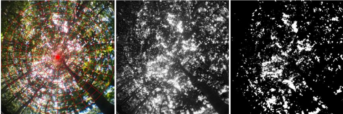
Figura 3.1.10 Immagine a colori (a sinistra), banda del blu a gradazione di grigio (al centro), in bianco e nero con Treshold impostata (a destra) per suddividere le porzioni di cielo da quelle occupate da foglie e rami
