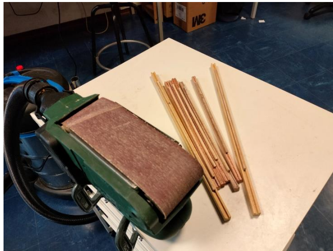
Figura 2.2.2.2 Levigatura dei campioni tramite levigatrice elettrica con nastro in carta abrasiva
