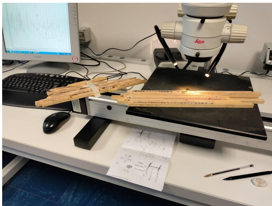
Figura 2.2.2.3 Postazione di misurazione degli anelli legnosi con sistema LinTab presso il TreeringLab del D3A
