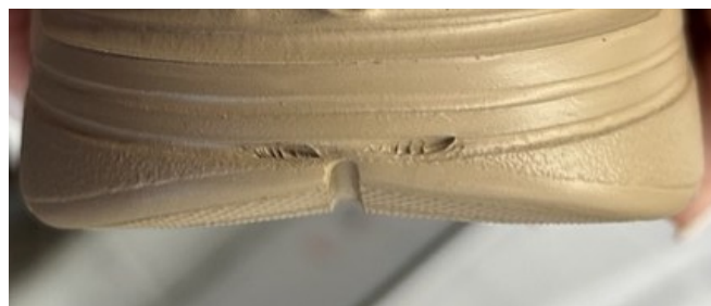
Figura 10: Difetto "trattenuto" su una suola, azienda Dami
