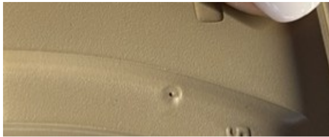
Figura 11: Difetto "bolla" su una suola, azienda Dami
