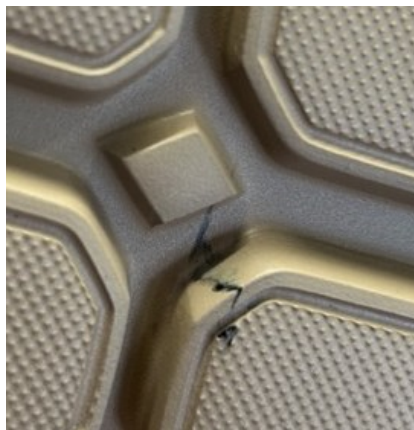
Figura 12: Difetto "macchia di colore" su una suola, azienda Dami
