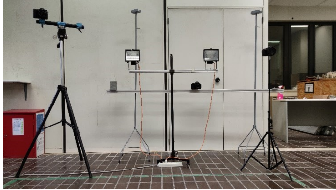
Figura 2.4: Sistema a tre camere
