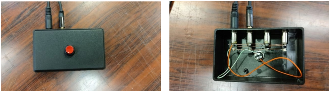
Figura 2.2: Pulsante di scatto (sinistra), circuito interno (destra)
