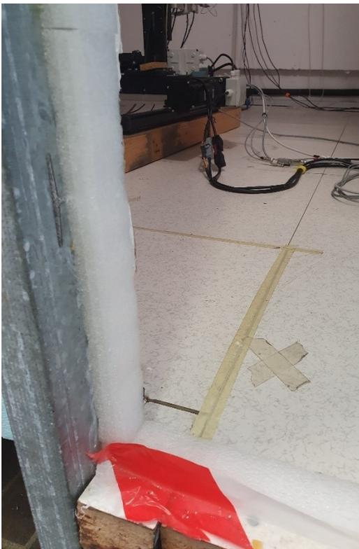
*Figura 32: plastica espansa incollata nel telaio in alluminio della porta*
