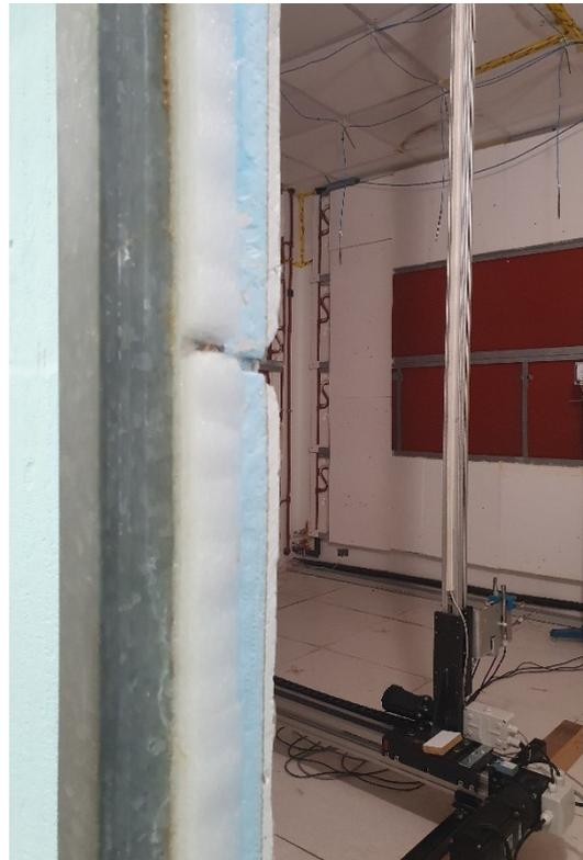
*Figura 33: plastica espansa incollata nel telaio in alluminio della porta*
