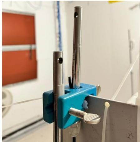
Figura 60: anemometri per la misura di  $V_x$  e  $V_z$  posizionati sul supporto
