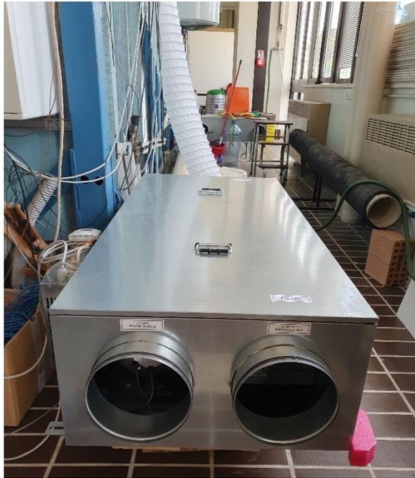
*Figura 49: unità di ventilazione meccanica con recuperatore "Roccheggiani DRU"*
