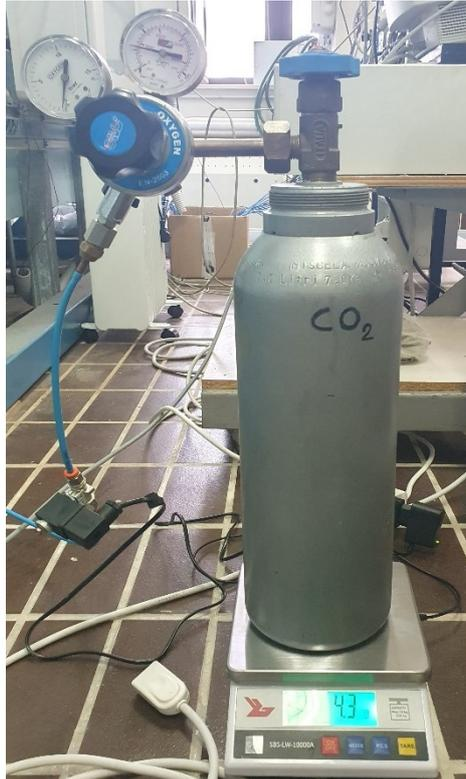
*Figura 43: bombola con sistema riduttore di pressione ed elettrovalvola Camozzi U7J*
