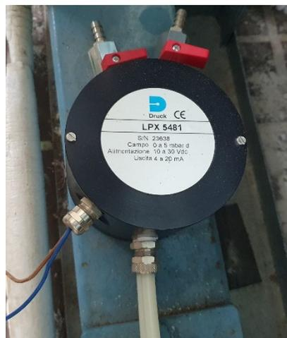
*Figura 51: trasduttore di pressione differenziale "Druck LPX 5481"*
