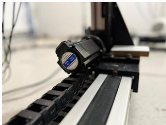
*Figura 57: guida dell'asta orizzontale e motore passo-passo dell'asta verticale*
