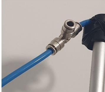
Figura 47: ugello di erogazione collegato al tubo flessibile in gomma
