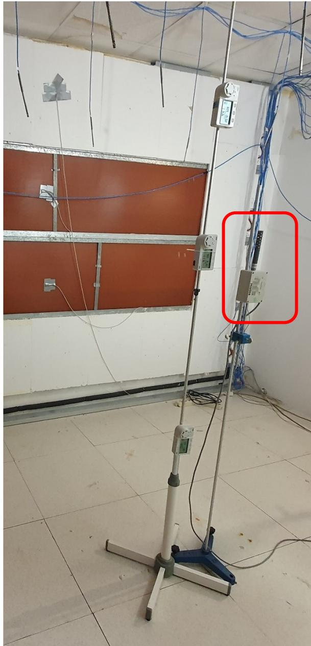
*Figura 41: a sinistra l'asta con i sensori HOBO® e a destra quella con il sensore Lastem*
