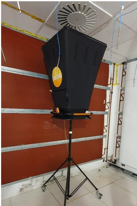
Figura 53: balometro "Testo 420" nella fase di posizionamento
