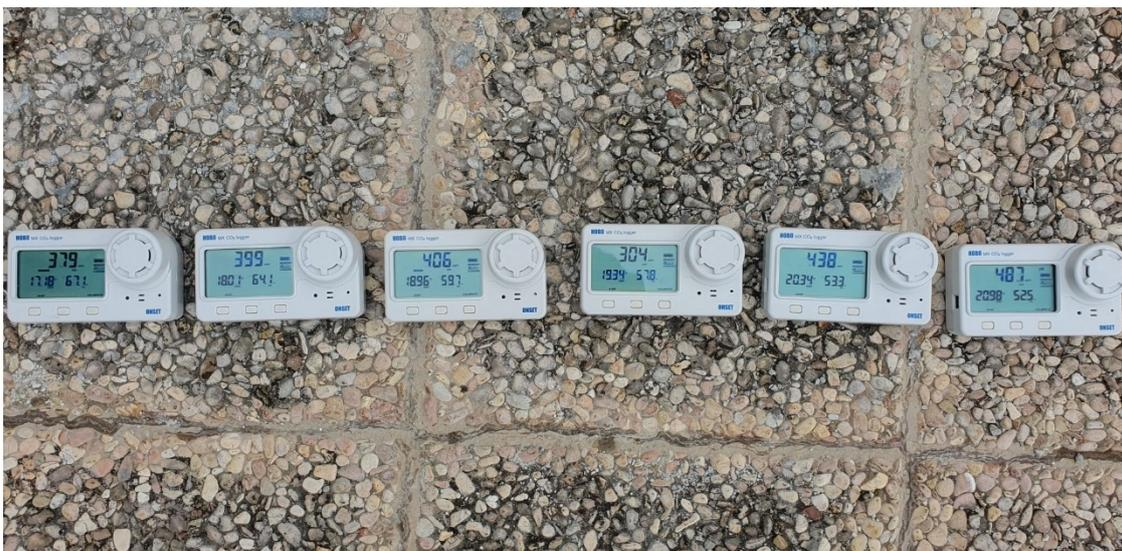
*Figura 35: sensori HOBO® in fase di calibrazione*
