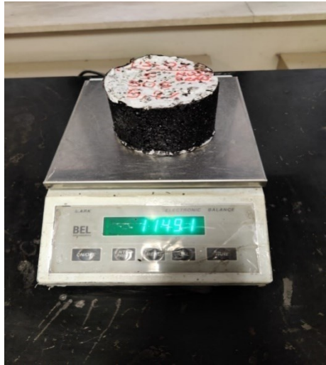
Figura 39 - Bilancia per peso in aria
