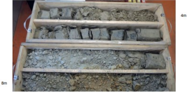
Figura 3 - Cassette catalogatrici con materiale estratto
