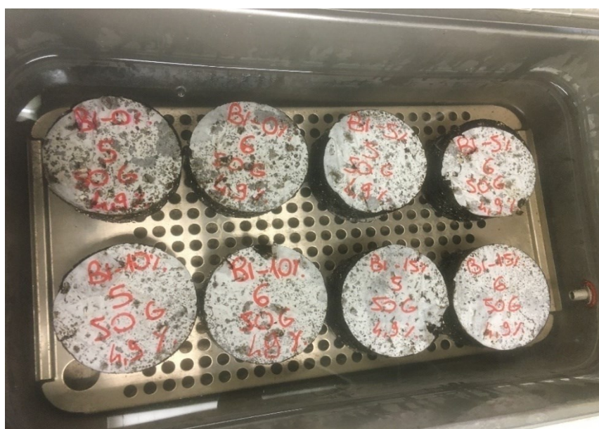
Figura 45 - Serie di provini durante il condizionamento in acqua
