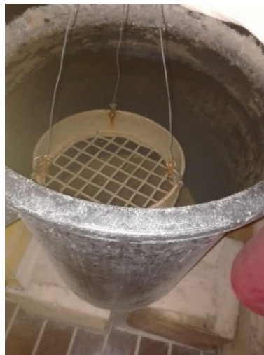
Figura 40 - Bilancia per peso in acqua
