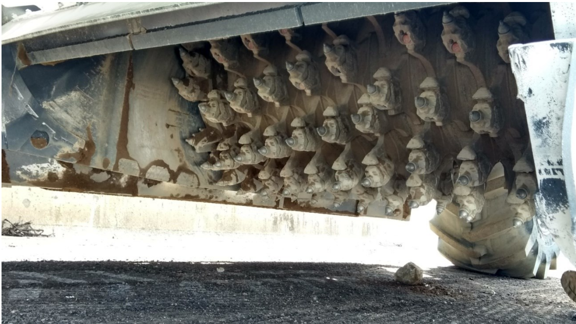
Figura 29 - rotore di miscelazione con denti
