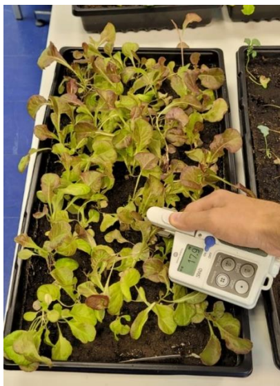
Figura 3-13: A sinistra, una rilevazione dei valori di clorofilla tramite SPAD; a destra, la misurazione del numero di foglie e altezza delle piantine di un vassoio.
