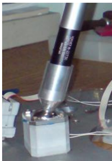
Figura 3.30: Prototipo fisico di un giunto a sfera auto-bloccabile. [14]
