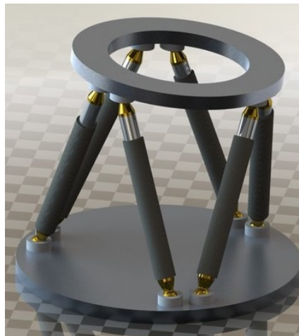
Figura 4.2: Esempio di piattaforma Gough-Stewart [16]
