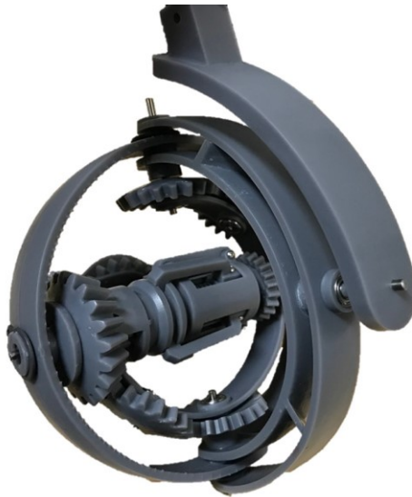
Figura 1.1: Giunto universale riconfigurabile realizzato con tecniche di prototipazione rapida. [1]
