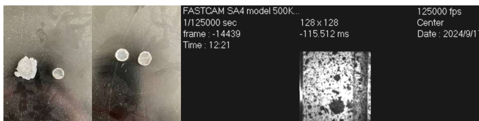
9. Da sinistra a destra: nelle prime due immagini, troviamo un confronto pre-post test; a destra un estratto relativo a un test ritraente un attimo prima della rottura.
