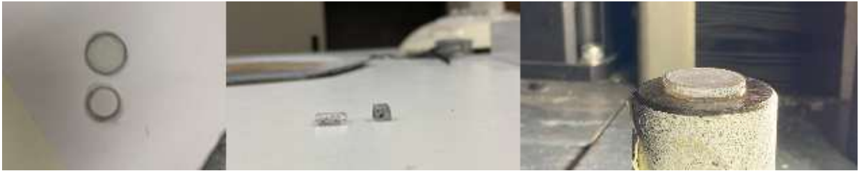
8. In foto, un confronto tra i provini destinati a compressione statica, notare quanto sia apprezzabile la differenza nei provini simil-cubici.
