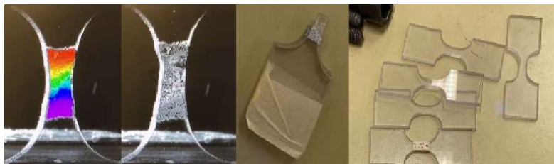
7. Da sinistra a destra vediamo il piano di scorrimento, la rottura del provino e un confronto tra il provino pre-post test a trazione statica.
