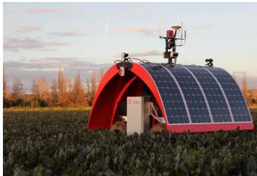
Figura 1.2: Robot di monitoraggio Ladybird. [5]
