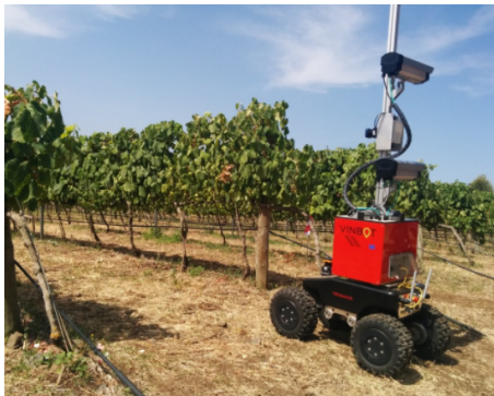
Figura 1.1: VINBOT all'opera all'interno di un vigneto. [4]
