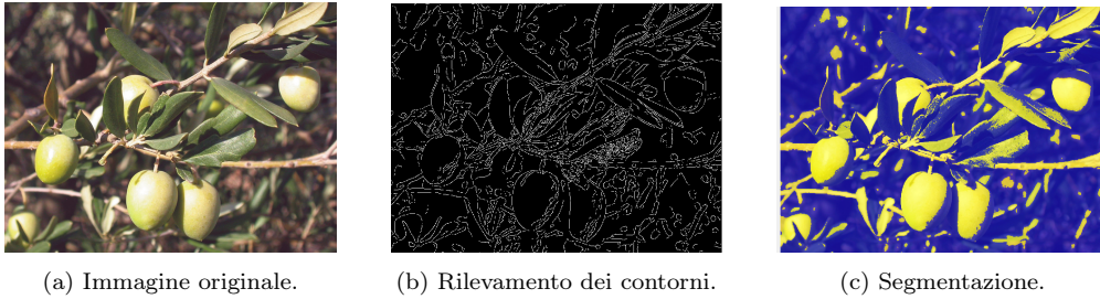
Figura 2.1: Segmentazione e rilevamento dei contorni applicati ad un'immagine di olive.
