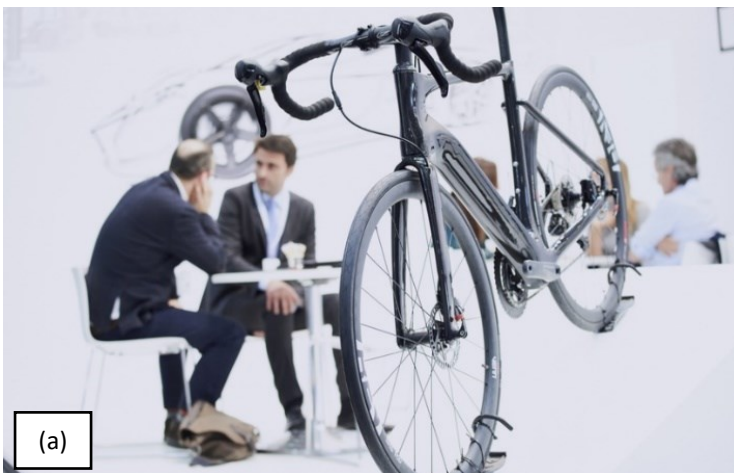
Fig. 10 – Telaio di bicicletta sportiva (a) e racchetta da tennis in fibra di carbonio (b)
