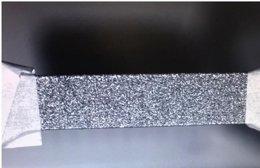
In Figura 5-5 si può notare che non è stata eseguita nessuna verniciatura, avendo infatti la superficie del provino una buona rugosità, si è sfruttata questa caratteristica per ottenere i marker di cui seguire gli spostamenti. Le immagini acquisite sembrano
