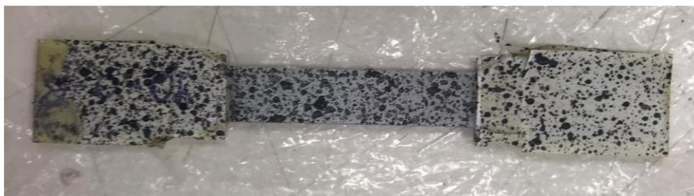
La tecnica di misurazione in questione è una misurazione della deformazione tramite delle immagini catturate da una o più telecamere. Nel nostro caso è stata utilizzata la tecnica 3D che richiede di due telecamere per effettuare la misurazione. Durante la prova le due telecamere catturano delle immagini del tratto verniciato, con una frequenza di un frame al secondo.
