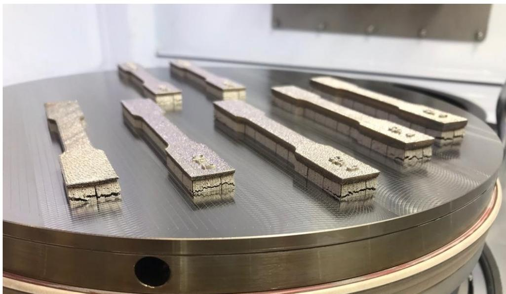
Come si può notare durante la stampa si è verificata la rottura dei supporti che collegano i provini al piatto. Questo fatto è dovuto alla deformazione che il provino subisce a causa dell'effetto termico. Durante la stampa il componente subisce infatti un ciclo termico di continui riscaldamenti e raffreddamenti.
