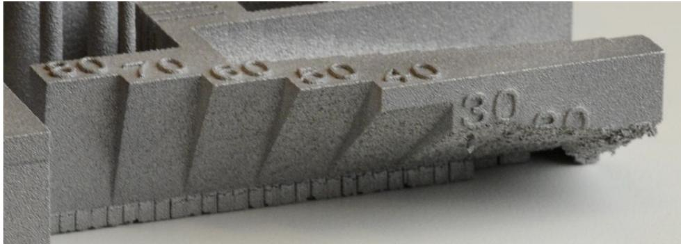
2. *Spessori delle pareti* < 0,5mm andrebbero evitati anche se possibili, il valore dello spessore minimo dipende fortemente dei parametri e dalla geometria, inoltre se supportate gli spessori possono diminuire.
