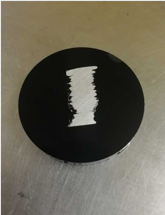
Figura 4.5 e 4.6: graffi dovuti ad una bassa granulometria (sx) e pezzo completamente lucidato tramite carta abrasiva 4000 e pronto per l'analisi al MO (dx).
