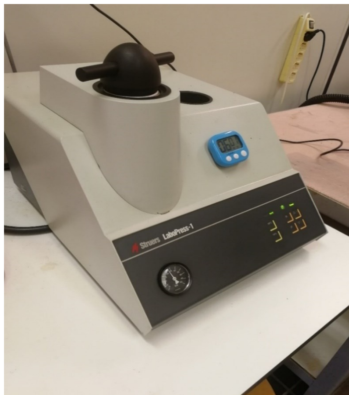
Figura 4.1: macchina per l'inglobatura.
