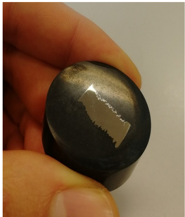
Figura 4.5 e 4.6: graffi dovuti ad una bassa granulometria (sx) e pezzo completamente lucidato tramite carta abrasiva 4000 e pronto per l'analisi al MO (dx).
