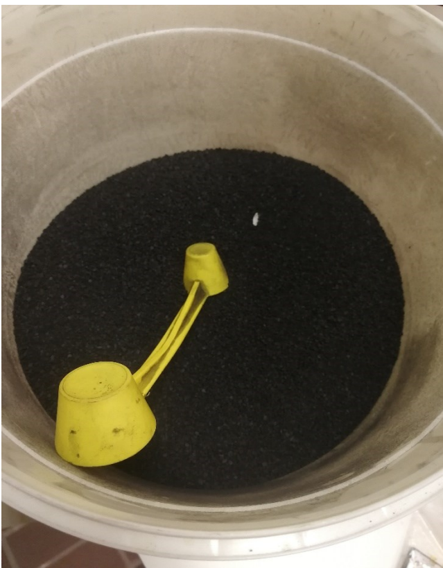
figura 4.2 e 4.3: resina fenolica utilizzata (sx) e pezzo inglobato (dx).
