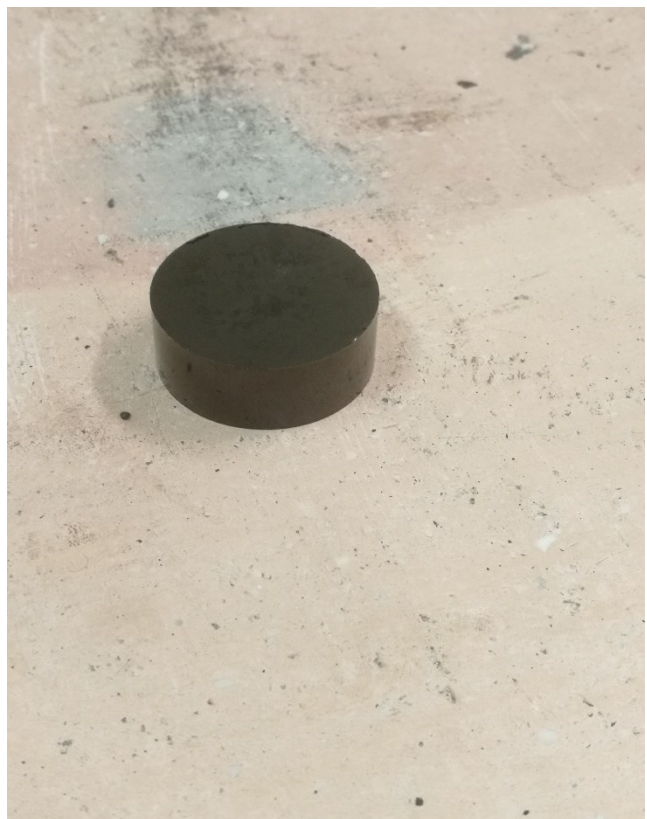
figura 4.2 e 4.3: resina fenolica utilizzata (sx) e pezzo inglobato (dx).
