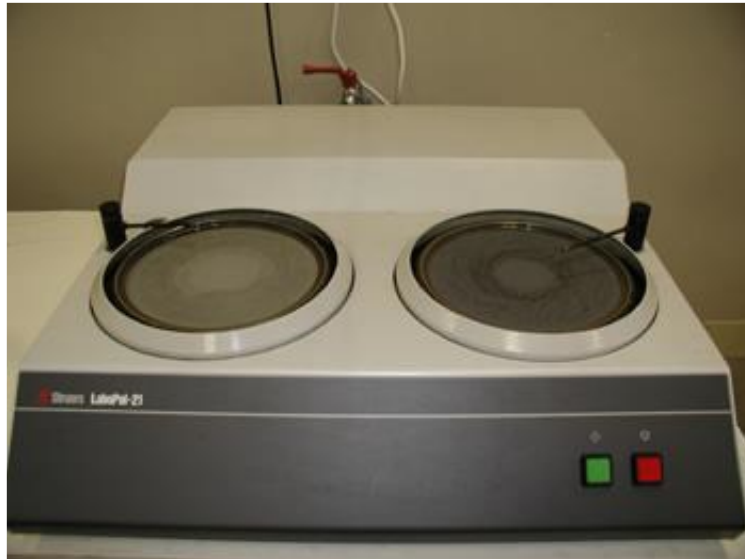
figura 4.4: macchina utilizzata per la lucidatura del campione.
