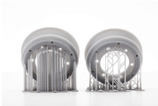
Figura 1.3: creazione supporti e orientamento del pezzo.
