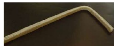
Figura 13- dettaglio connettori ad L in GFRP
