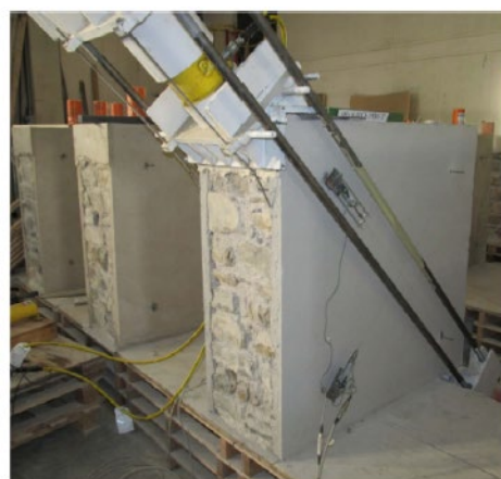
Figura 14- Apparato sperimentale per il test di compressione diagonale montato su un provino
