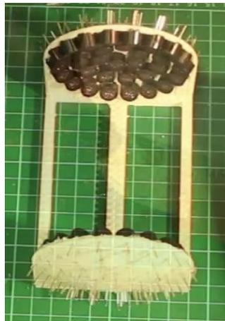
Questo numero di trasduttori genera una forza sufficiente per far levitare i campioni e mantenere il processo di esecuzione; tuttavia, è possibile aggiungere più trasduttori, aumentando l'intensità delle forze di cattura, andando però così a gravare sui costi e complessità del prototipo.
