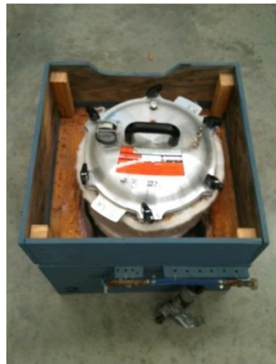
Figura 16: Autoclave alloggiata in box coibentato.
