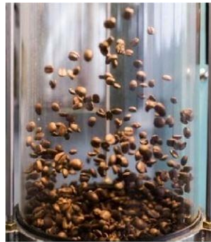
Figura 77: : Caffè in fase di tostatura all'interno di un cilindro di vetro borosilicato. I grani di caffè vengono mantenuti in sospensione e continuamente miscelati da un flusso di aria dal basso verso l'alto
