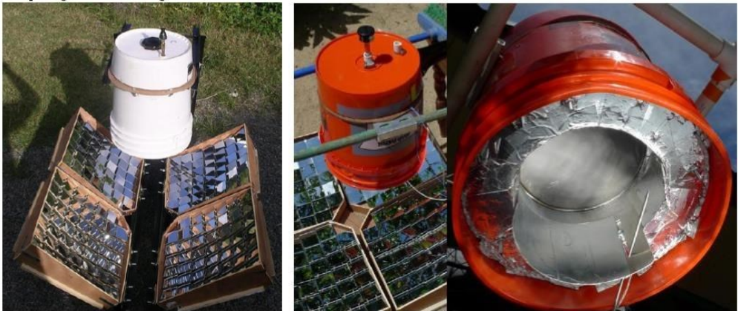
Figure 11: Evoluzione seconda configurazione e dettaglio pentola a pressione con isolante
