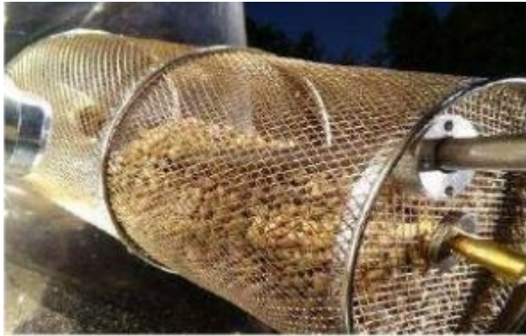
Figura 78: Caffè in fase di tostatura contenuto all'interno di un cestello rotante
