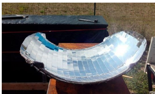
Figura 67: Il riflettore secondario realizzato in fogli di alluminio e inserito nella stufa
