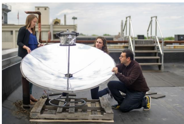
Figura 12: Sul tetto del MIT International Design Center, Gomez-Marquez aiuta le studentesse collaboratrici Anna Young (a sinistra) ed Elizabeth Phillips a montare un prototipo del Solarclave, uno sterilizzatore per strumenti medici. | Sam Ogden
