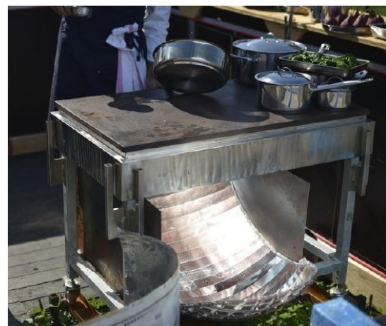
Figura 67: Il riflettore secondario realizzato in fogli di alluminio e inserito nella stufa
