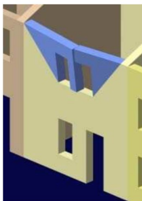
Figura 6.6 – Meccanismo di flessione orizzontale
