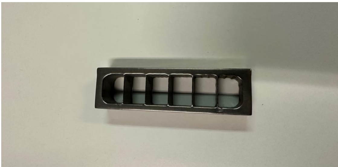
Figura 4.19 Vista frontale di una sezione sottoposta al processo di rimozione dei supporti
