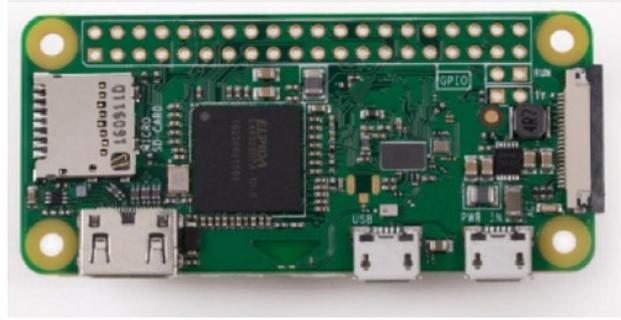
Figura 2.1 - Chip della *Raspberry Pi Zero W* utilizzata per l'acquisizione di immagini nel fotosegnalamento.
