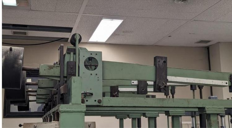
*Figura 12: Sistema di leva macchina Creep*
