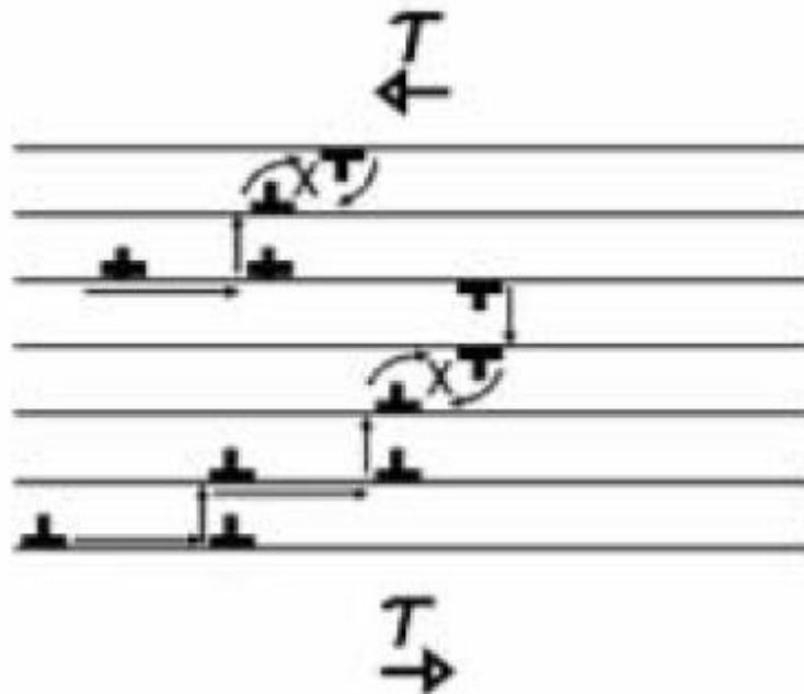
Figura 4: Movimento di dislocazioni a spigolo ad alta temperatura, scorrimenti (orizzontali) e salti (verticali) fino ad incontrare dislocazioni di segno opposto annullandosi [1]
