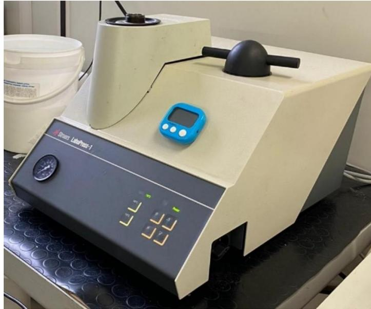
*Figura 13: Inglobatrice Struers Labopress 1*
