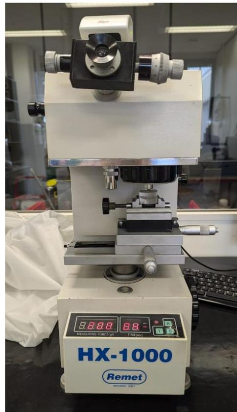
Figura 17: Macchina di microdurezza Remet HX-1000
