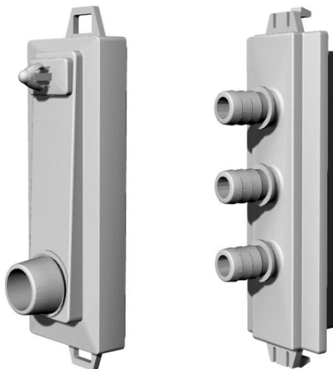
Figura 8: Modello 3d collettore inferiore (sinistra) e superiore (destra)
