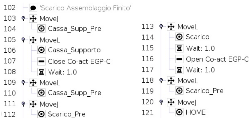
Figura 4.12: Scarico del componente assemblato
