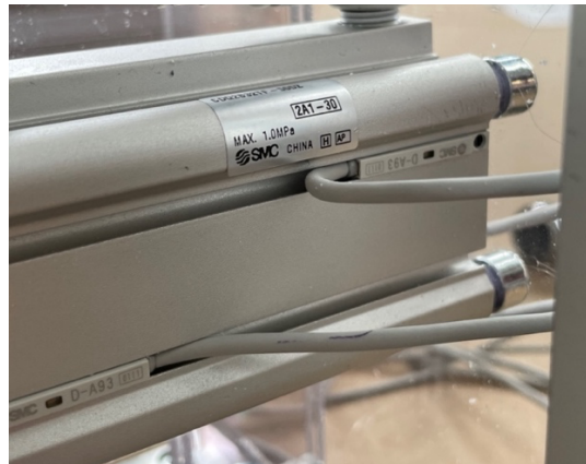
Figura 3.15: Sensori collegati al pistone pneumatico
