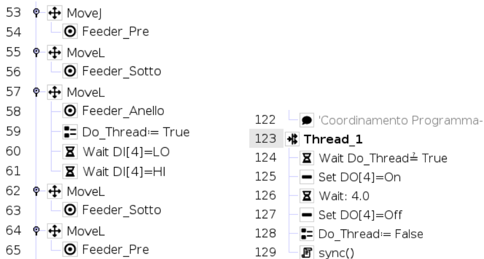
Figura 4.7: Alimentazione dell'anello mediante feeder e Thread
