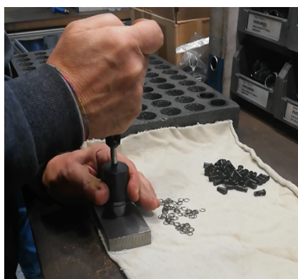
Figura 2.2: Operatore mentre usa lo strumento per inserire l'anello di arresto
