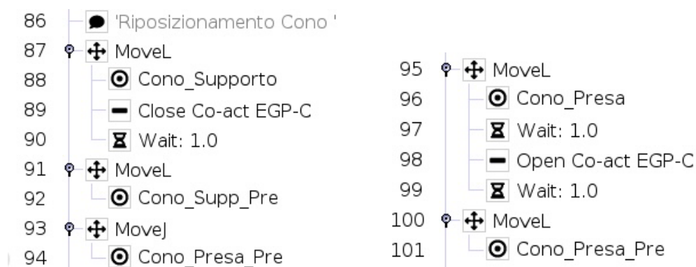
Figura 4.11: Riposizionamento del cono di inserimento
