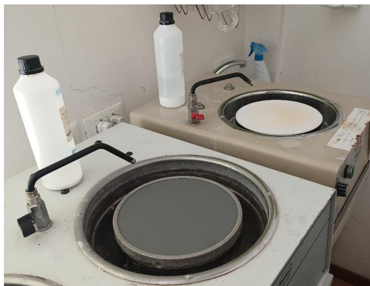
Figura 33. Lapidelli utilizzati in laboratorio per il sezionamento longitudinale delle vertebre di Raja asterias . Sulla sx dell'immagine lapidello con il panno abrasivo da 1000 micron, sulla dx lapidello montante il panno per la lucidatura finale.
