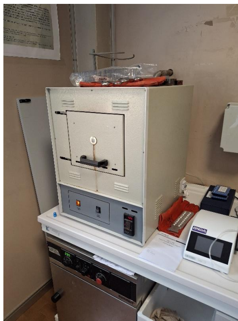
Figura 31. Muffola utilizzata per la bruciatura delle vertebre di Raja asterias .
