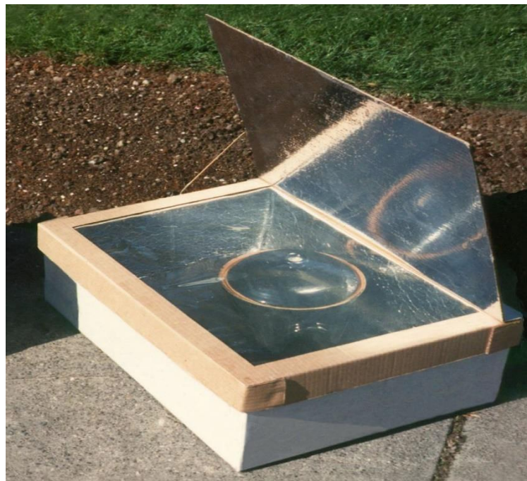
Fig. 6: un forno solare a scatola [7]
