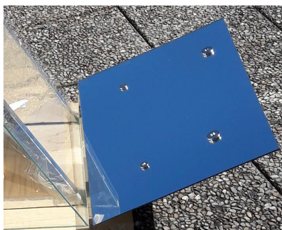
Fig. 11: particolare: i magneti di fissaggio
