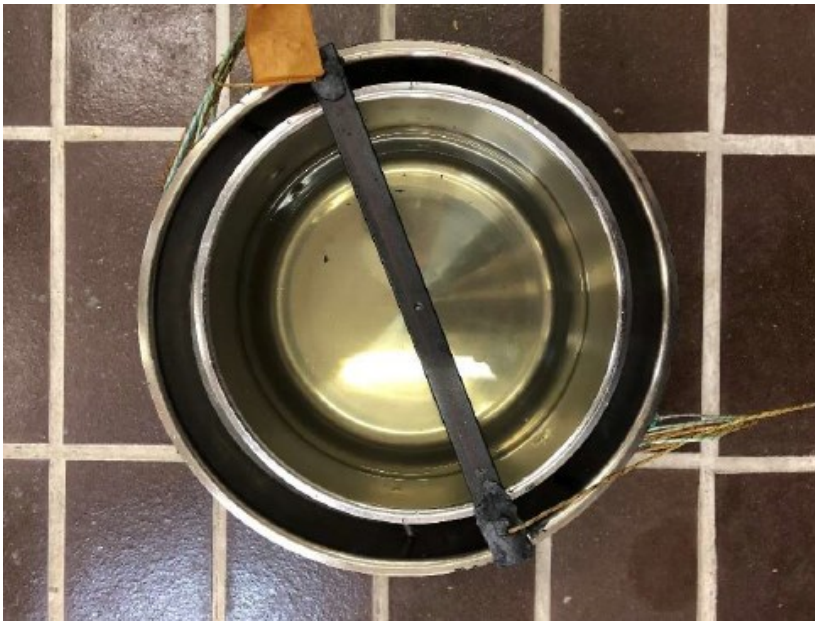
Figura 8 - Pentola con doppio fondo per prove con PCM
