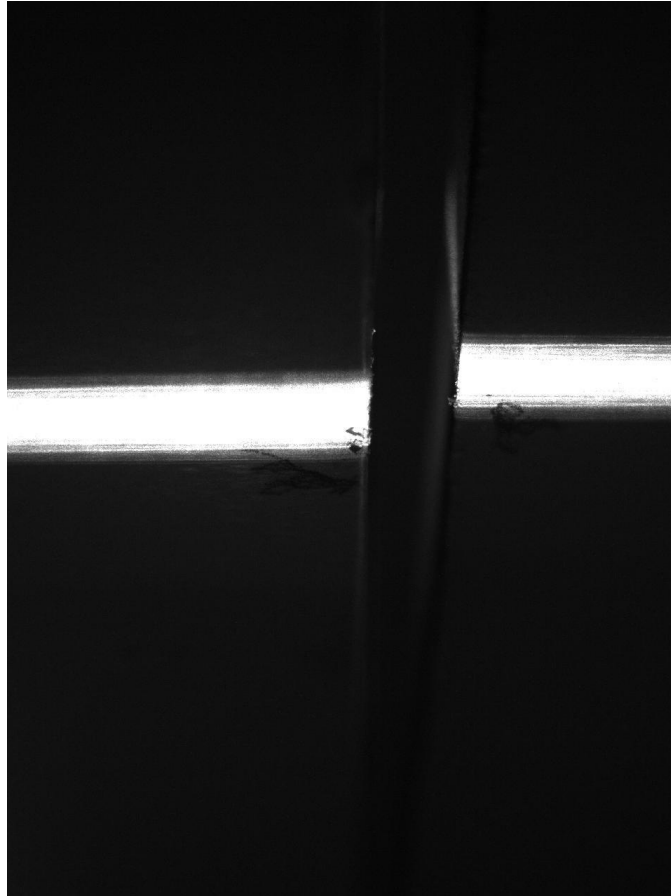
Figura 36 Foto prototipo con il laser blu Gap 2.20mm e flush 1.37mm
