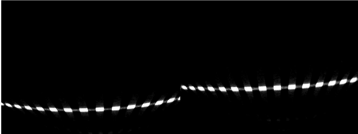
Figura 19 Immagine prototipo G3F laser rosso distanza 1mm(sinistra) e distanza 6mm(destra)
