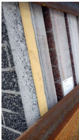
Figura 2 esempio pannello sandwich con anima isolante e rivestimento in calcestruzzo,
