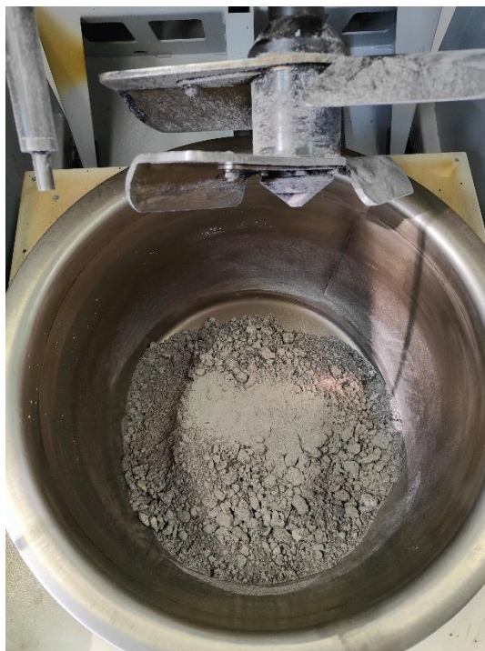
Figura 4.10 – Aggiunta del cemento
