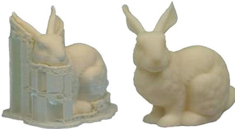
*Figura 2.11 Materiale di supporto per consentire la stampa di caratteristiche sporgenti*
