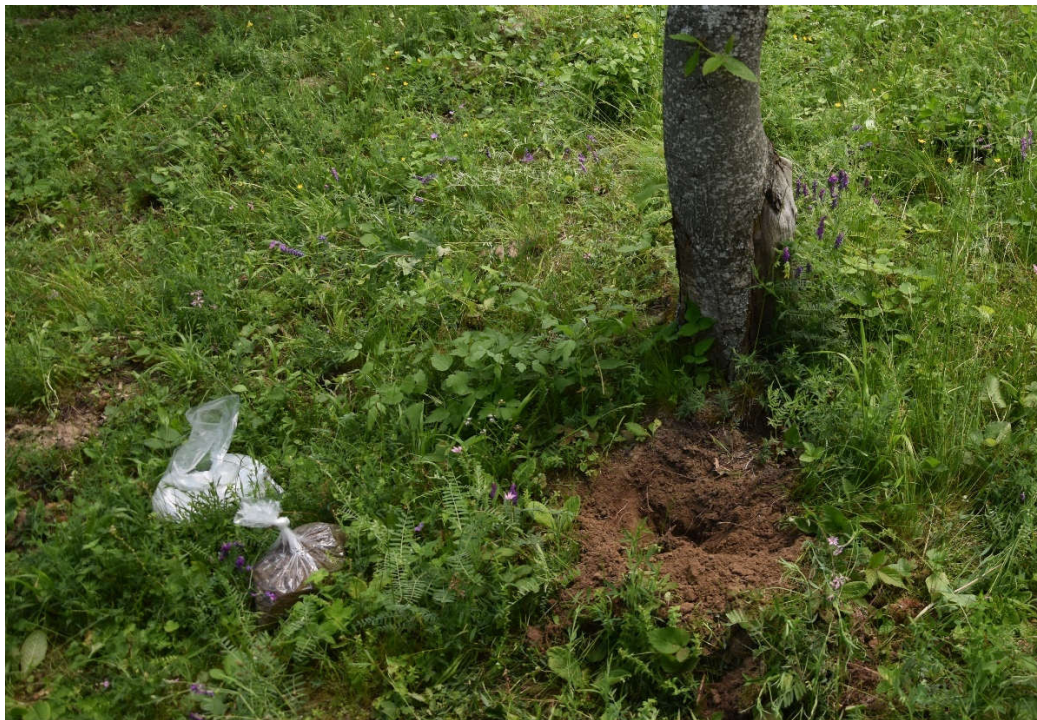
Figura 5-3: Operazioni di scavo e raccolta dei campioni di suolo.
