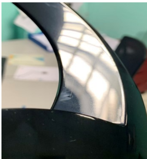
Figura 4.1: Componente HE001 con opacità nei pressi del punto di iniezione
