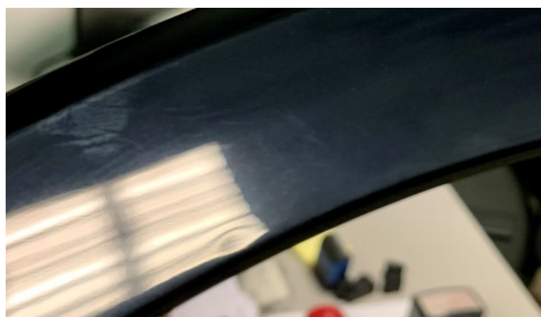
Figura 4.2: Componente HE001 senza opacità nei pressi del punto di iniezione dopo la modifica dei parametri di processo
