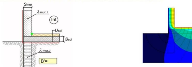
[Fig. 2.7]: Ponte Termico di tipo GF
