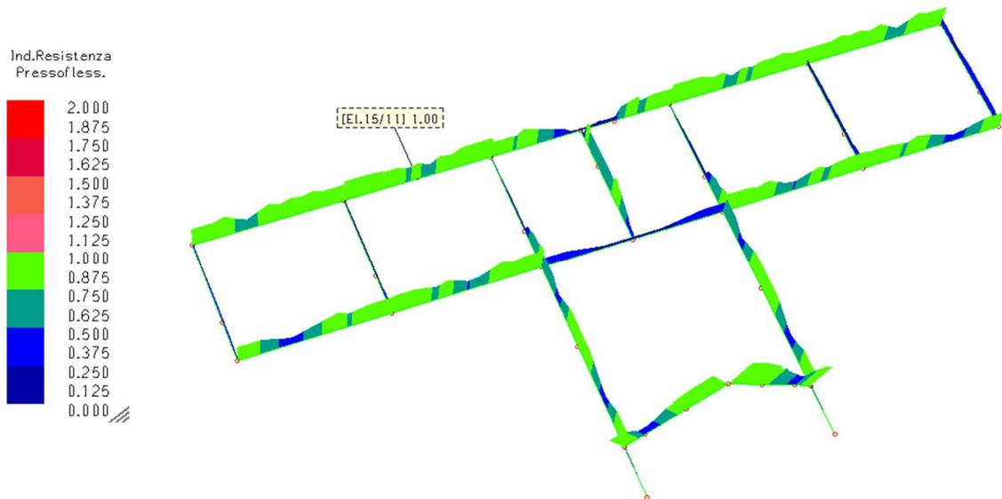
*Fig. 4.18-Indici di resistenza a pressoflessione per le travi in c.a. della copertura.*
