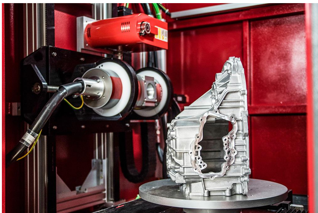
Figura 1.27: Pezzo sottoposto a tomografia industriale
