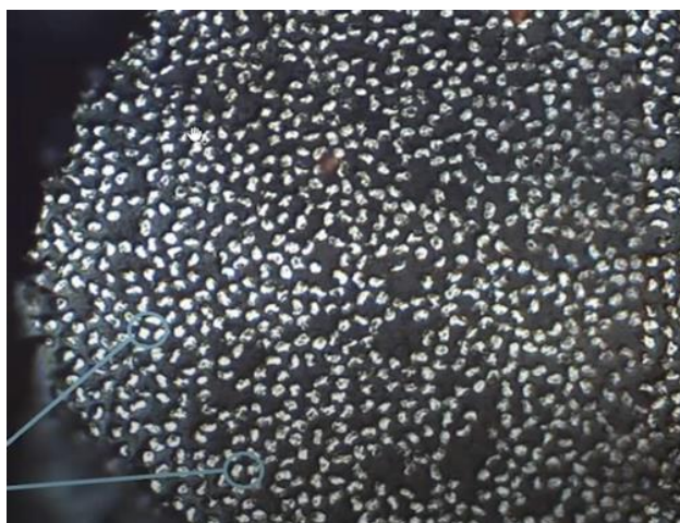
Figura 2.2: Sezione di un filamento di CCF 1.5k Anisoprint
