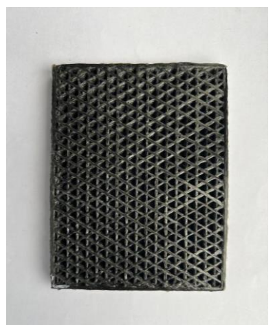
Figura 3.31: Vista frontale della Isogrid al 50%
