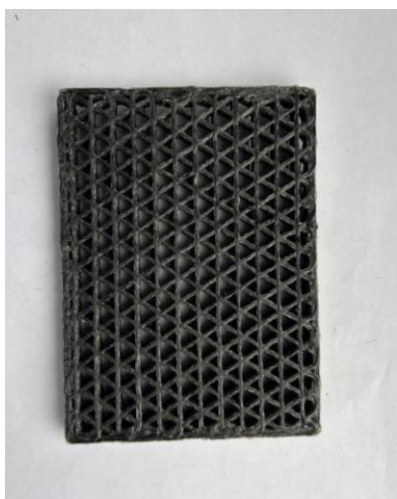
Figura 3.27: Vista frontale della Isogrid al 35%
