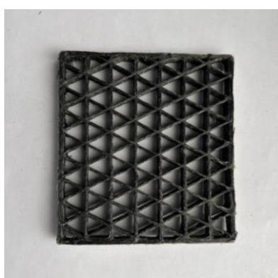
Figura 3.25: Vista frontale della Isogrid al 20%
