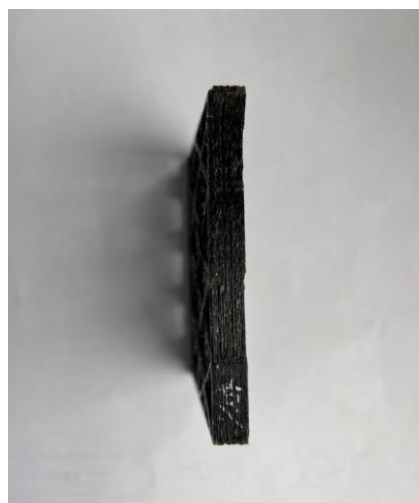
Figura 3.34: Vista laterale dell'Anisogrid al 10%
