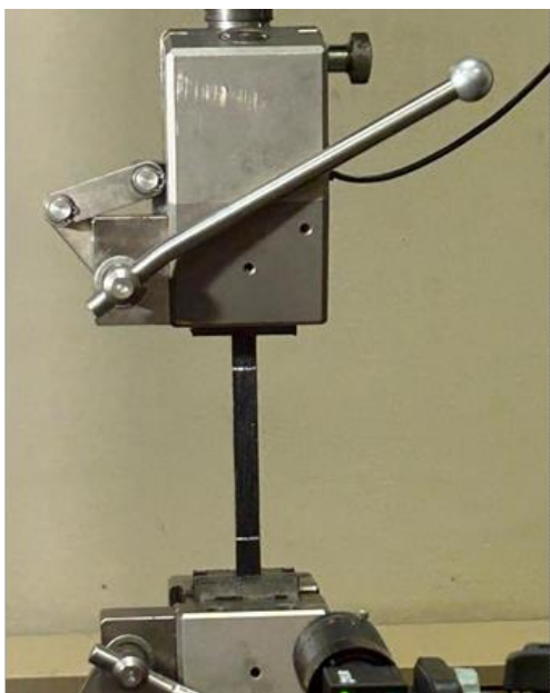
Figura 2.19: Provino sottoposto alla prova di trazione
