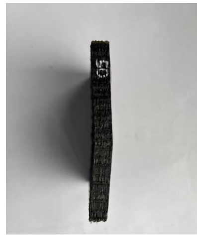
Figura 3.32: Vista laterale della Isogrid al 50%
