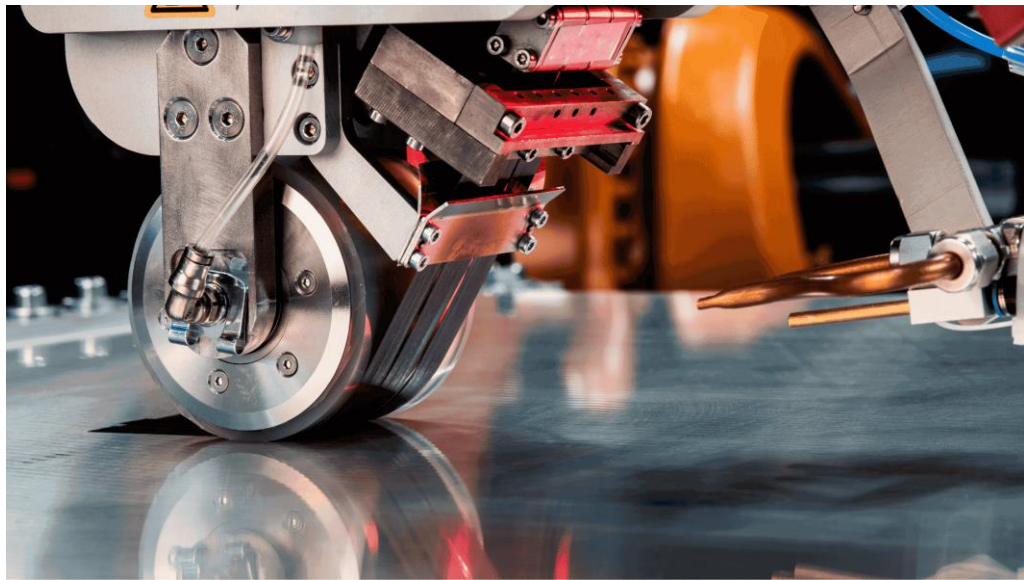
Figura 1.22: Stampa AFP, deposito del materiale
