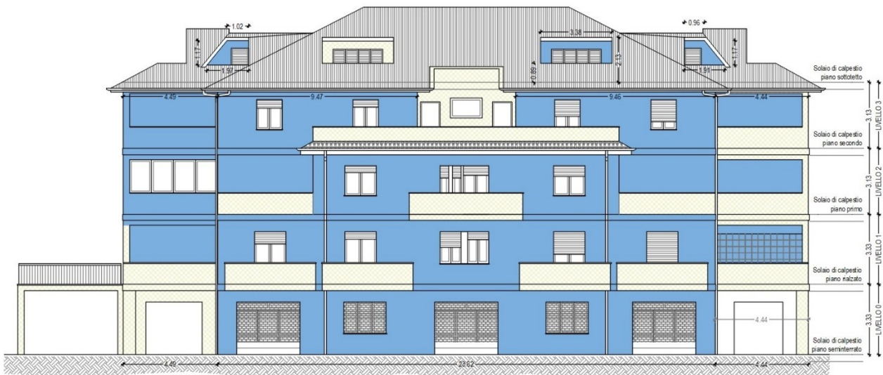
Figura 36 – Prospetto intervento superfici opache
