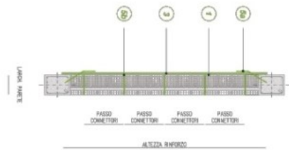
SEZIONE A - A' RINFORZO DELLA TAMPONATURA TRAMITE GEO GRID 120 O GEOSTEEL GRID 200/400 O RINFORZO ARV 100
