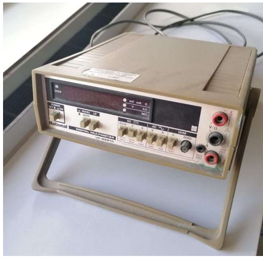
Fig. 2.6 – Voltmetro utilizzato per rilevare il potenziale delle barre di armatura nei cicli
