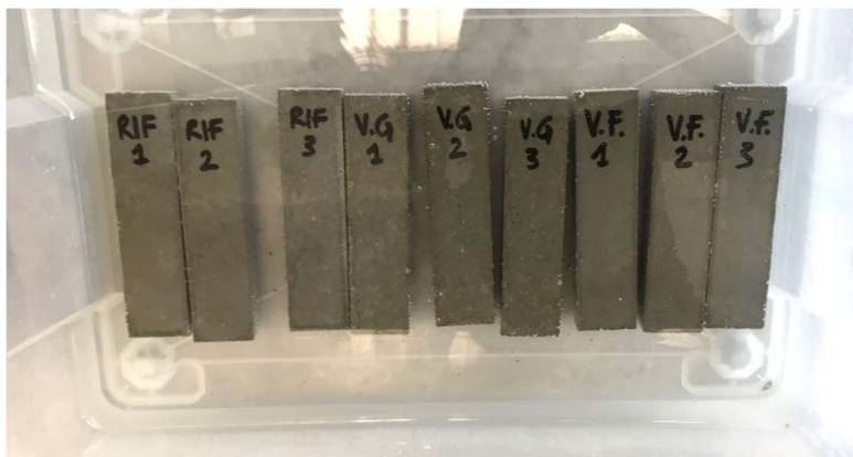
Fig. 2.28 – Provini immersi nella soluzione di NaOH
