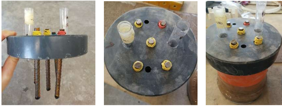
Fig. 2.3 – Barre di armatura e provette fissate al coperchio forato utilizzato durante il getto della miscela
