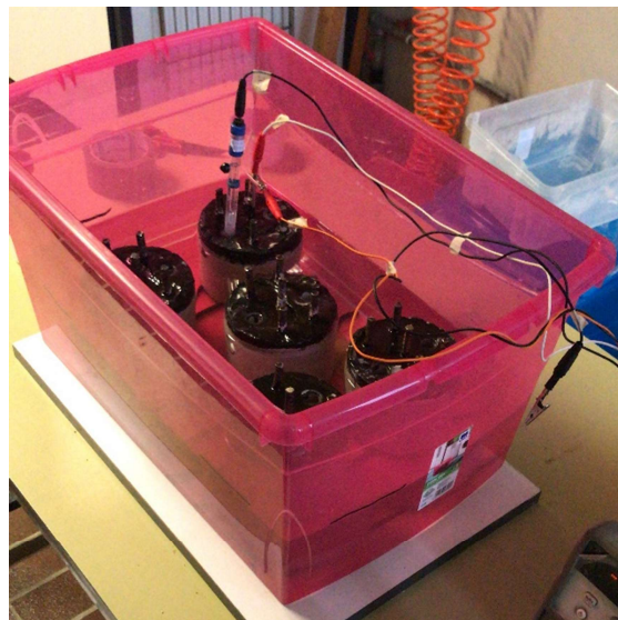
Fig.2.8 – Misura ed acquisizione dei dati del potenziale di corrosione durante la fase umida
