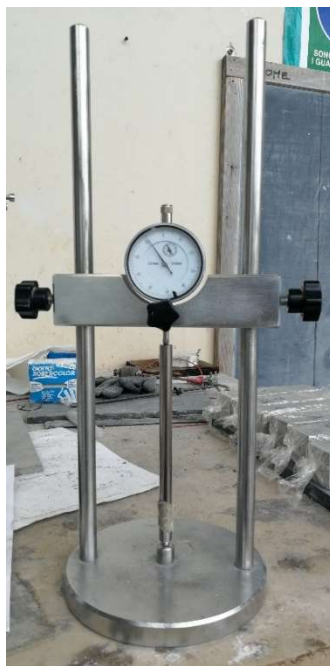
Fig. 2.30 – Calibratura del micrometro
