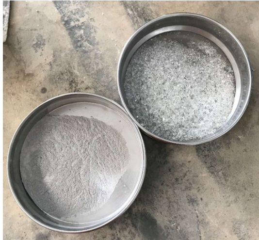
Fig. 2.23 – Frazioni di vetro ricavate dalla setacciatura manuale
