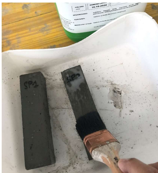
Fig. 2.35 - Provini della miscela “Covered” spennellati con il compound
