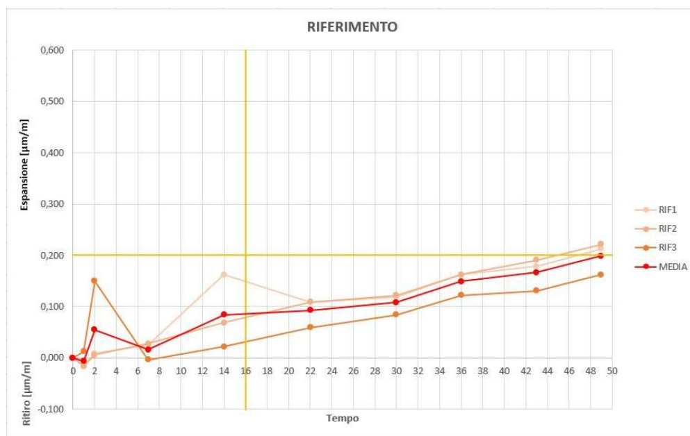
Fig. 2.30 – Grafico inerente alle letture dei provini di riferimento
