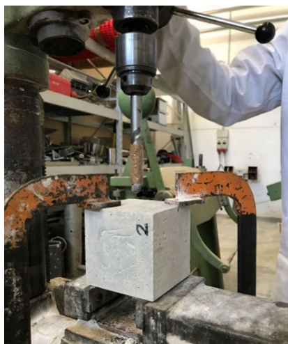
Fig. 2.10 – Trapano a colonna per il prelievo delle polveri per l'analisi del quantitativo di cloruri
