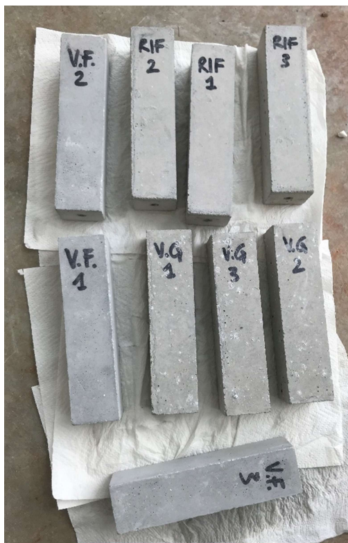
Fig. 2.34 – Provini a 49 giorni dell'analisi della reazione alcali-aggregato
