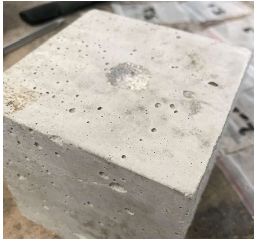
Fig. 2.11 – Provino cubico sottoposto al primo prelievo di polveri
