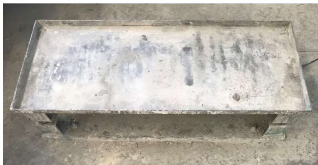
Fig. 2.26 – Tavola vibrante usata per la compattazione degli impasti
