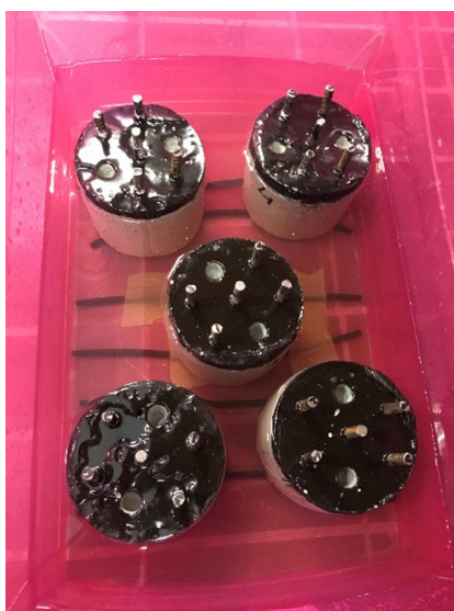
Fig. 2.4 – Provini cilindrici armati immersi nella soluzione salina 3,5% durante la fase umida
