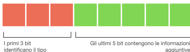
Figura 2.12: Raffigurazione della struttura del byte iniziale di un dato CBOR
