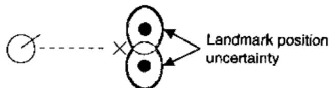
Figura 2.5: Ambiguità di misura: Due punti di riferimento (mostrati come cerchi neri) sono abbastanza vicini che l'osservazione (mostrata come una x ) potrebbe plausibilmente provenire da uno dei due. Immagine da [48]
