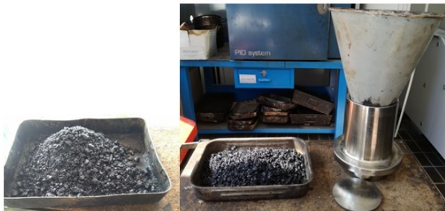
Fig.2.29 Conglomerato pronto per la compattazione
