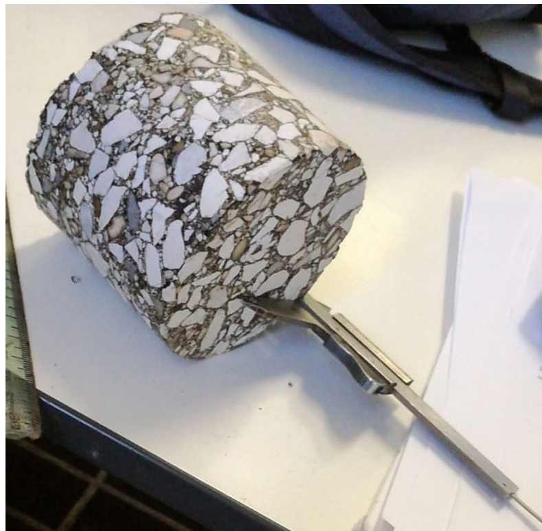
Fig.2.59 Misura di altezze e diametri mediante un calibro
