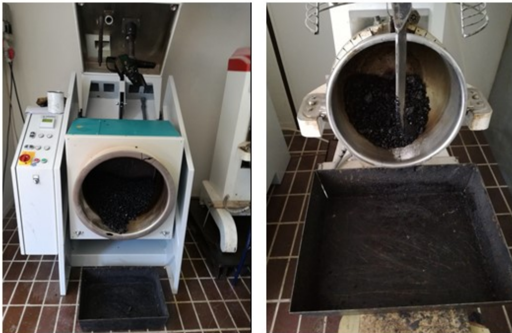
Fig. 2.28 : Impastatrici con all'interno il conglomerato a fine miscelazione
