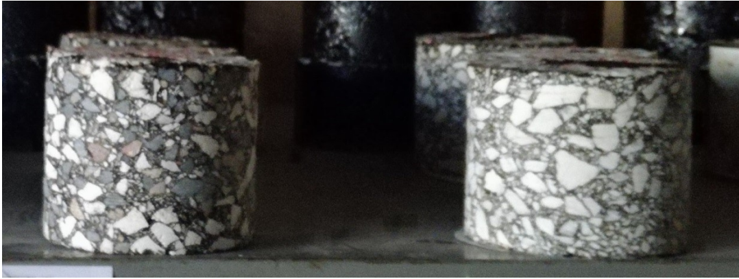
Fig.2.58 Provini dopo l'operazione di carotaggio
