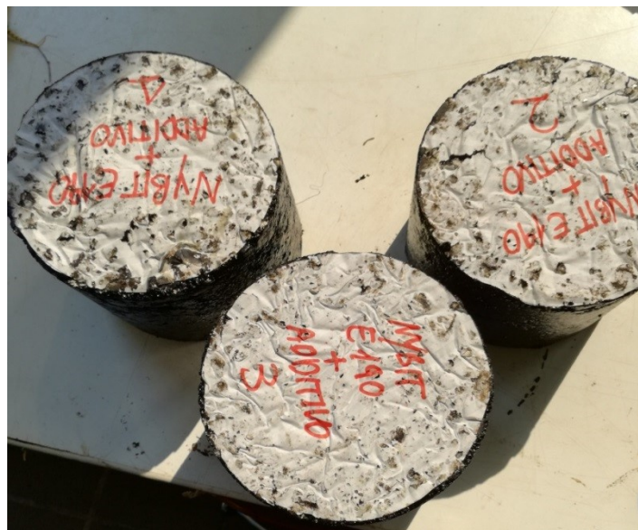
Fig.2.57 Provini Mix C prima del carotaggio
