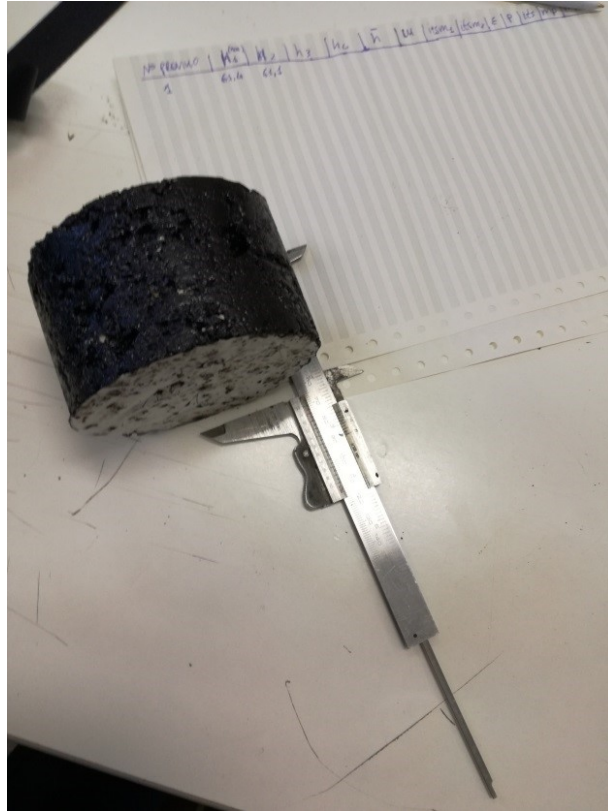
Fig.2.36 Misurazione delle quattro altezze del provino mediante un calibro
