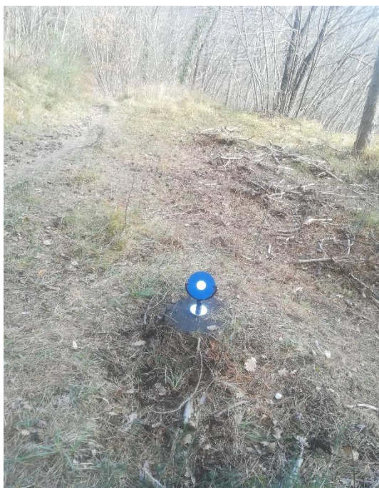
Figura 2.16: Punto di controllo a terra per rilevamento LIDAR terrestre
