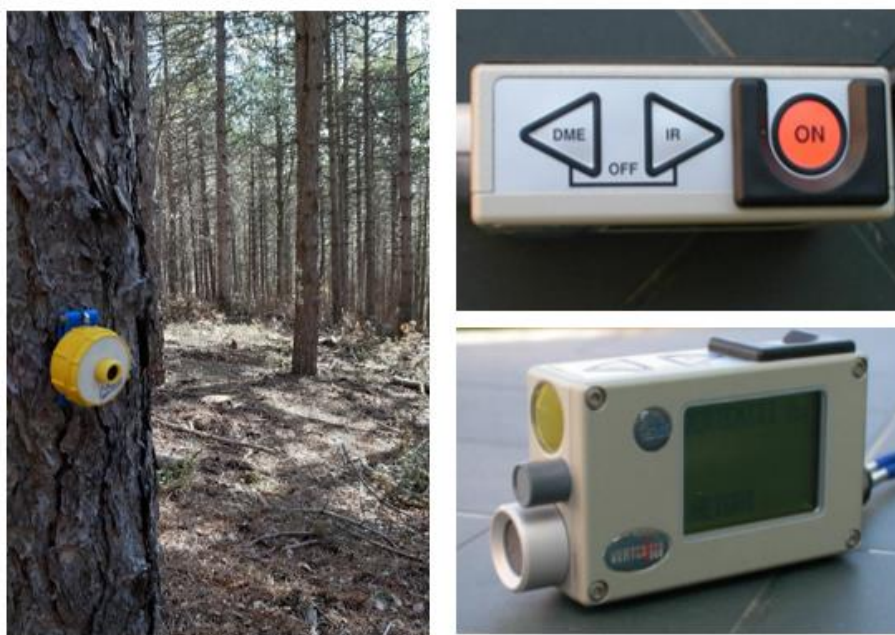
Figura 2.12: a sinistra trasponder posizionato sul fusto della pianta (G. Nespola 20/1/2021); a destra vertex (fonte: IFNC 2016)
