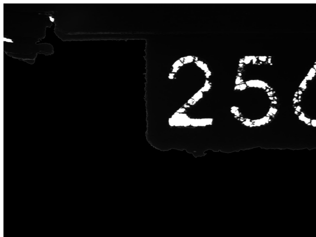
Figura 3.3: Immagine ottenuta dopo aver convertito lo sfondo da chiaro a scuro grazie all'uso della Blob Analysis.
