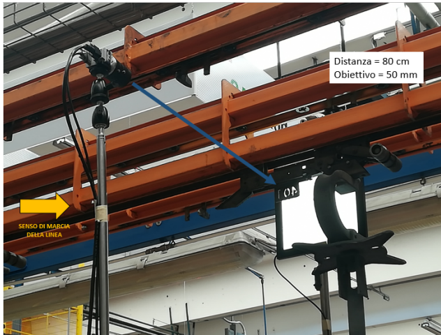
Figura 2.12: Set up definitivo usato per l'acquisizione delle immagini.
