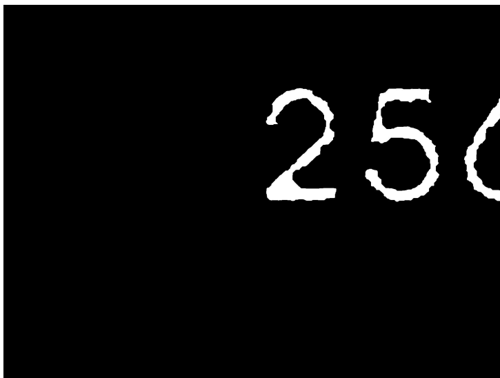
Figura 3.7: Immagine ottenuta dopo la rimozione degli elementi di disturbo bianchi attraverso la funzione bwareaopen .
