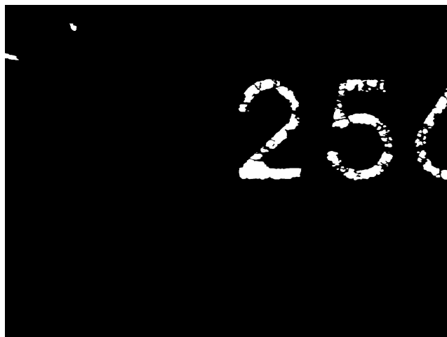
Figura 3.5: Immagine binaria ottenuta attraverso la funzione imbinarize
