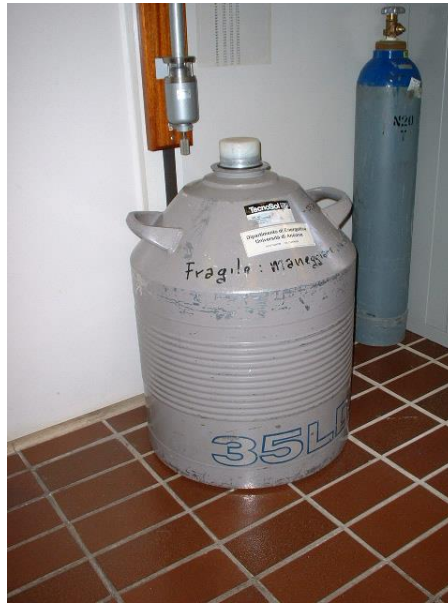
Fig. 3.12 - Dewar contenente azoto liquido
