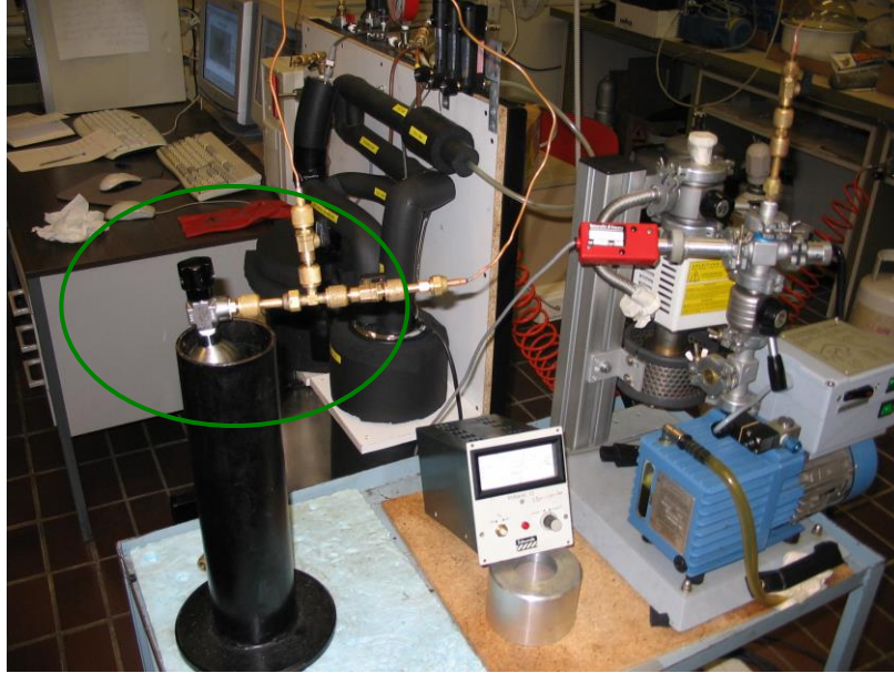
Fig. 4.4 - Raccordo a "T", bomboletta e pompa da vuoto
