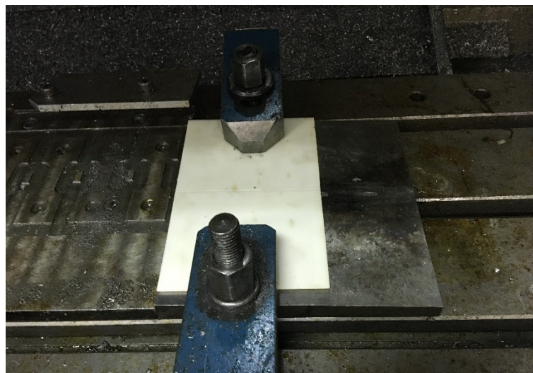
Figura 3.8 – Sistema di bloccaggio utilizzato per le piastre sottoposte a saldatura durante il processo di FSW.
