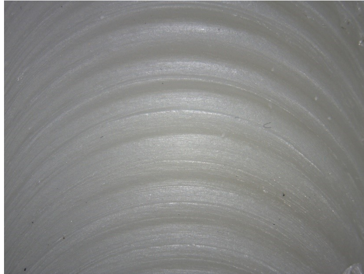
Figura 5.2 – Finitura superficiale del provino 1250-20-05 con zoom 16x.
