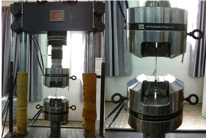
Figura 4.5 – Macchina di prova universale MTS 810 configurata per prova di trazione.
