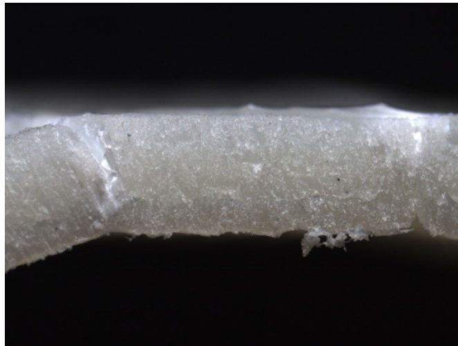
Figura 5.5 – Immagine ricavata dallo stereomicroscopio della struttura esterna del provino 800-40-04 a seguito della prova di piegatura
