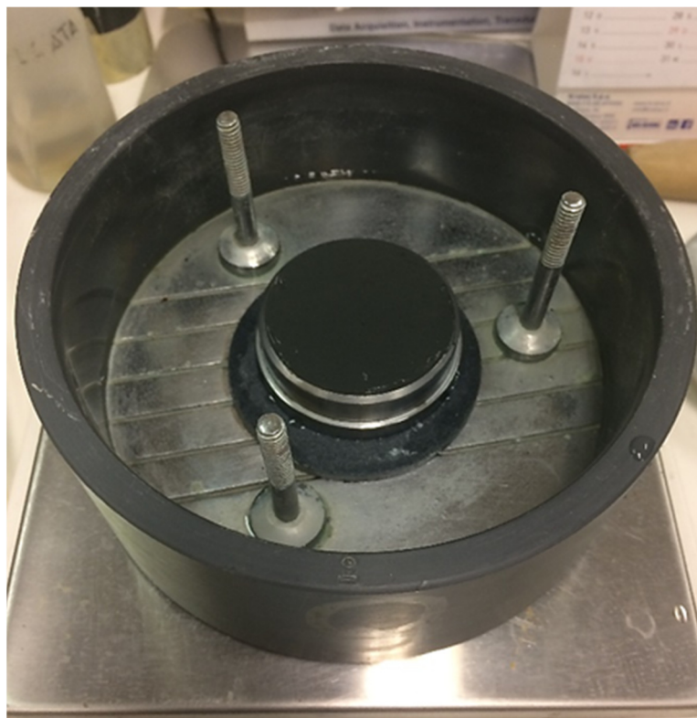
Figura 10: Posizionamento della fustella con sedimento sulla pietra porosa all'interno della base
