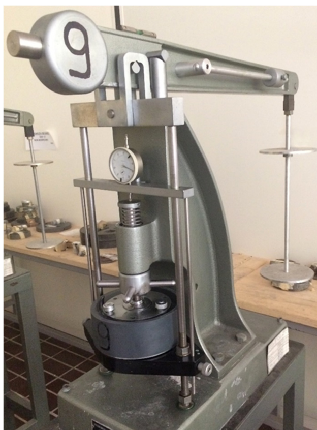
Figura 12: Edometro scarico con inserita la fustella
