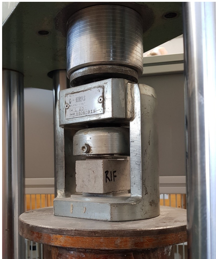
Figura 4.3.1: supporto metallico per prova a compressione e posizionamento del provino
