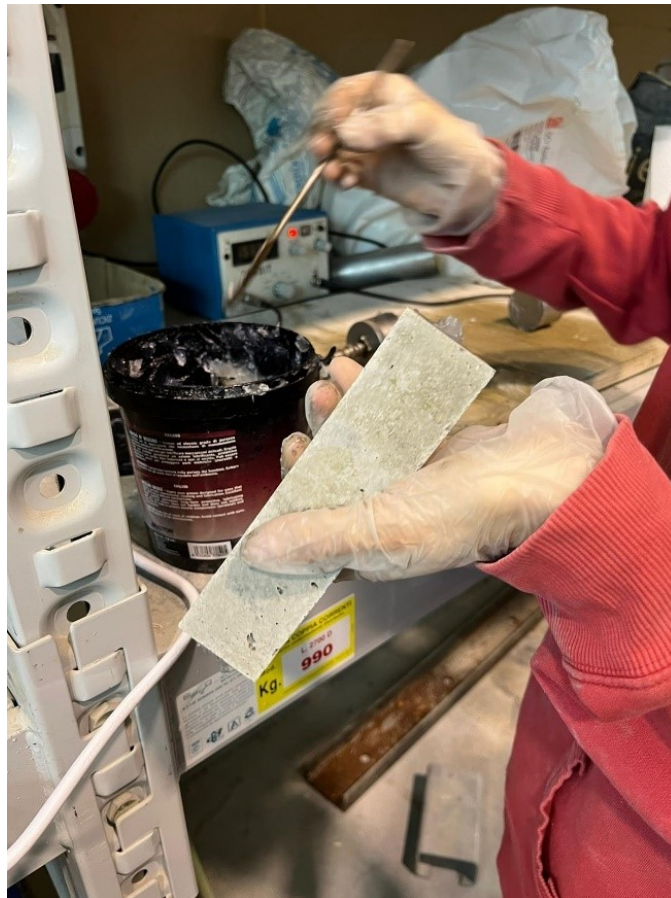
Figura 4.4.1: applicazione della vasellina sulle basi del provino
