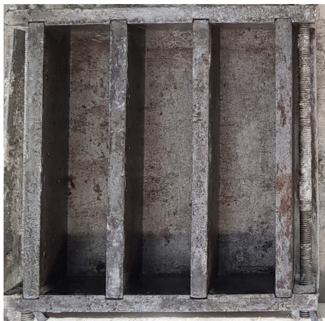
Figura 3.2.2: Cassero per provini usati nelle prove meccaniche
