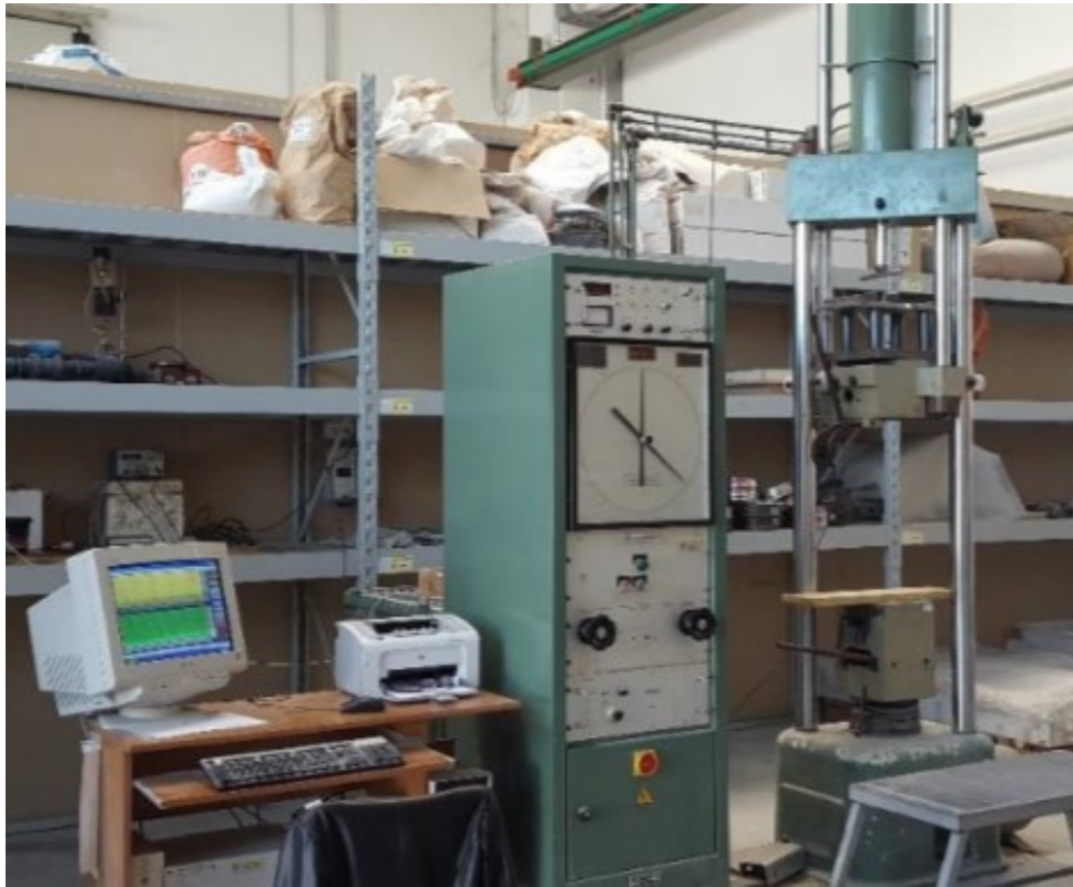
Figura 4.2.1: pressa idraulica per la prova a flessione e compressione
