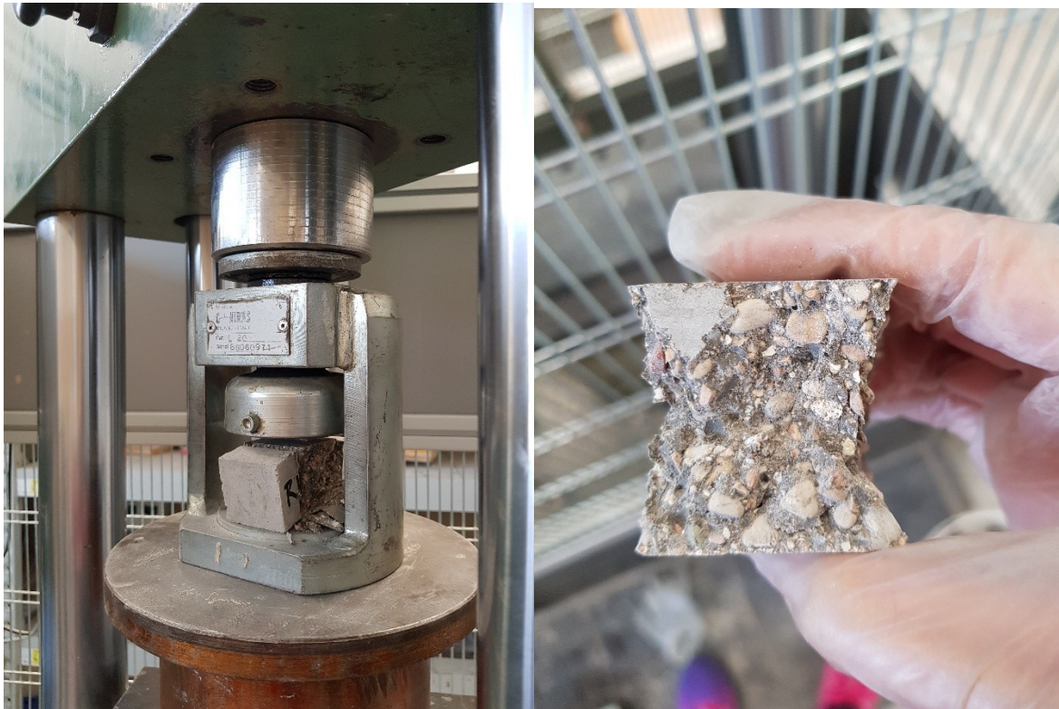
Figura 4.3.2: provino portato a rottura per compressione, forma a clessidra.
