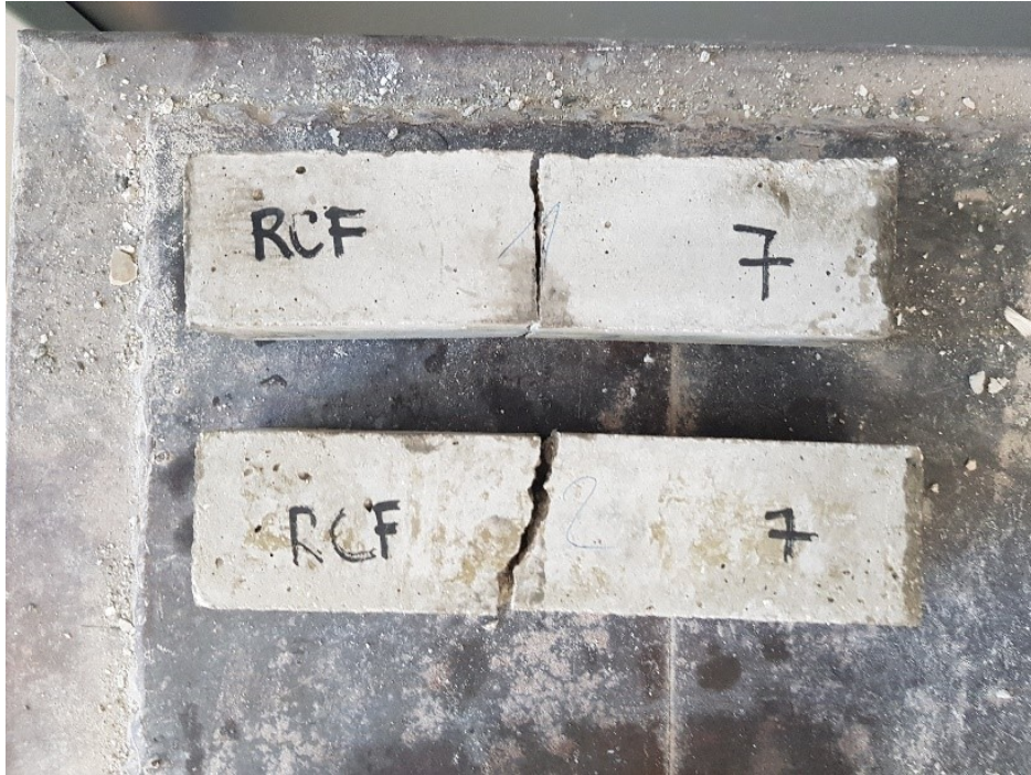
Figura 4.2.5: rottura del provino a flessione
