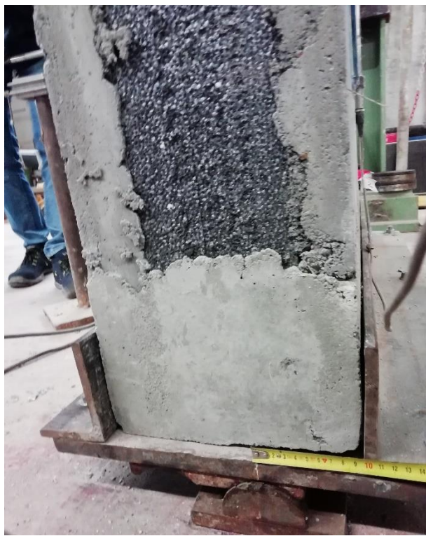
Figura 5.7– Setup di prova - Disposizione della cerniera cilindrica orizzontale al piede del provino
