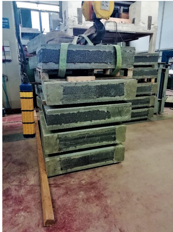
Figura 1.3 – Stratigrafia dei pannelli sandwich di forma quadrata testati in laboratorio prodotti dalla ditta TCS
