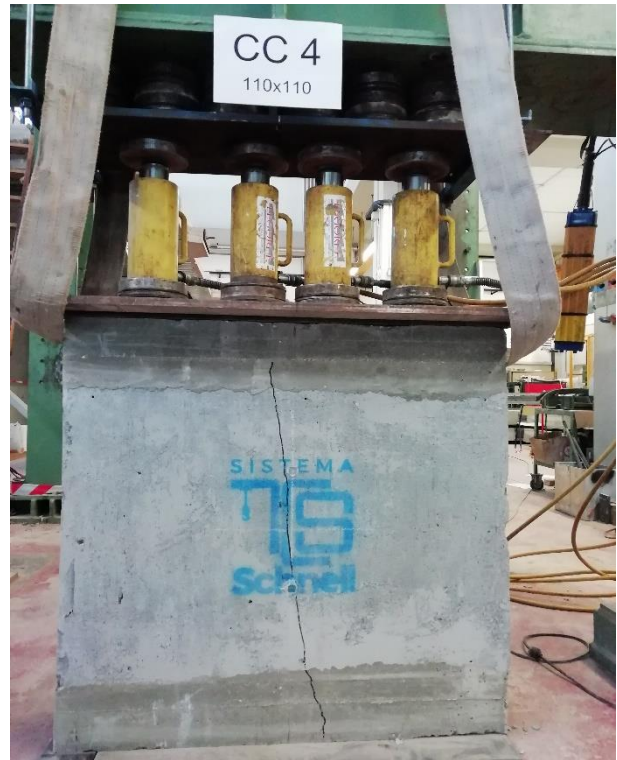
Figura 6.14 - Fessurazione verticale provino CC4
