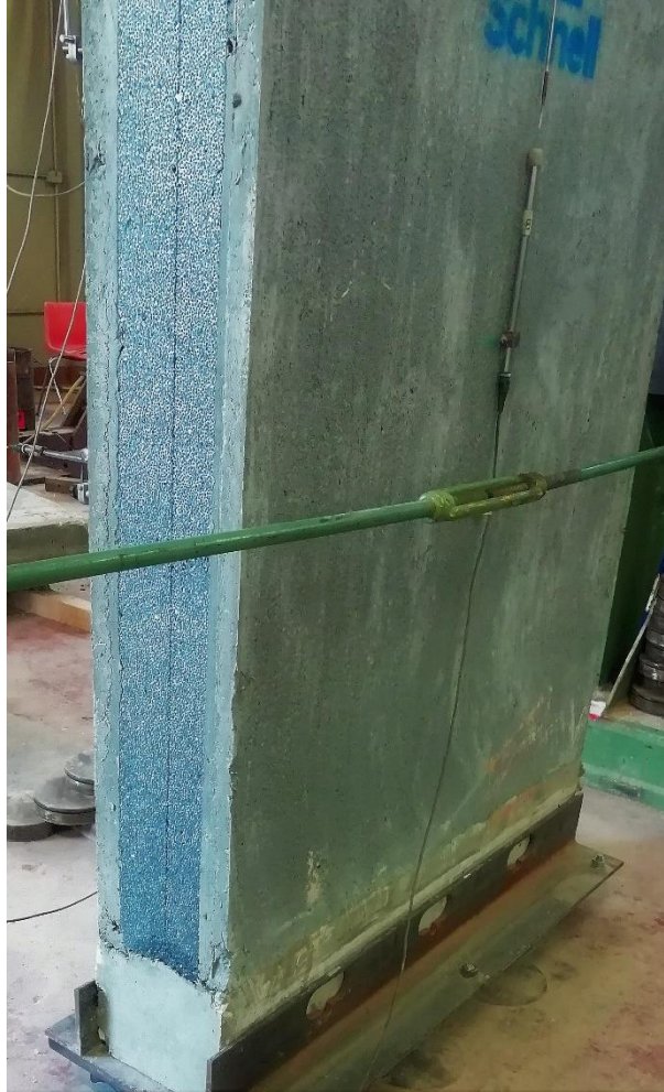
Figura 2.2 – Particolare del pannello sandwich oggetto di studio in cui si distinguono i due paramenti in calcestruzzo e lo strato isolante in EPS
