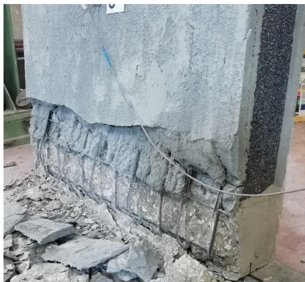
Figura 6.36 - Schiacciamento cordolo inferiore Ce3
