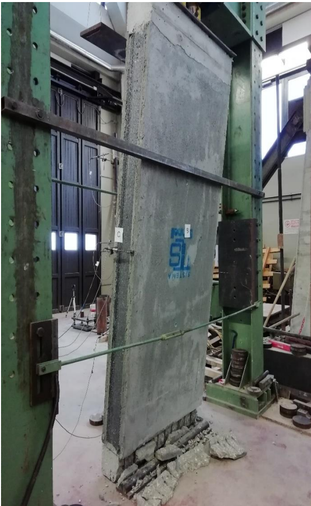
Figura 6.41 - Schiacciamento cordolo inferiore Ce1
