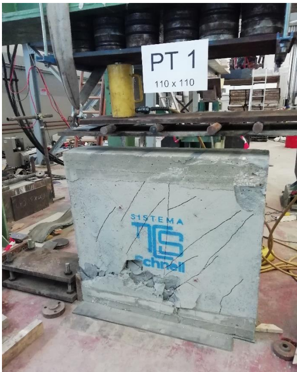
Figura 6.28 - Fessurazione diagonale e schiacciamento spigolo fronte PT1
