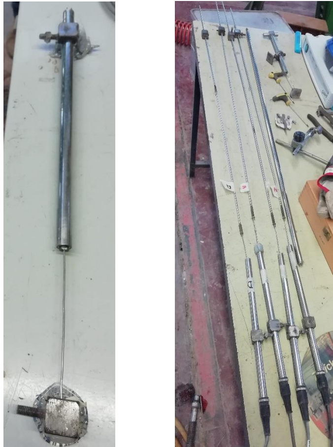
Figura 4.3 e 4.4 – Tipologie di trasduttori di spostamento induttivi LVDT utilizzate
