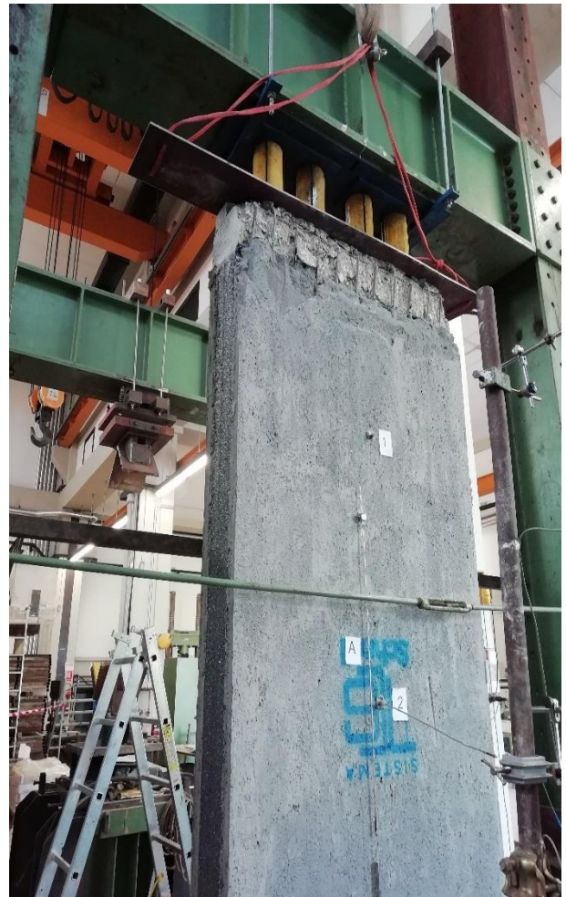
Figura 6.42 - Schiacciamento cordolo superiore Ce2
