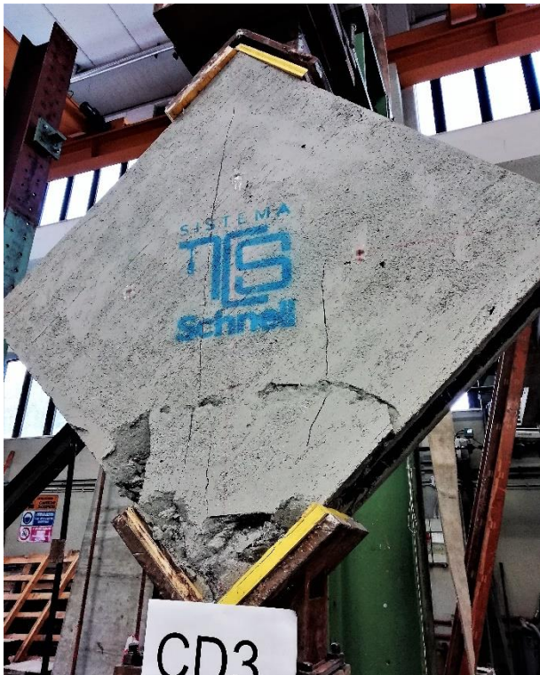
Figura 6.6 - Schiacciamento spigolo inferiore e fessurazione diagonale CD3 fronte
