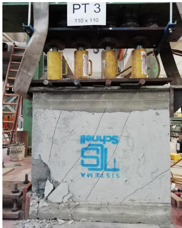
Figura 6.30 - Fessurazione diagonale e schiacciamento spigolo fronte PT3
