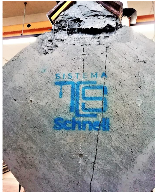
Figura 6.7 - Schiacciamento spigolo superiore e fessurazione diagonale CD4 retro
