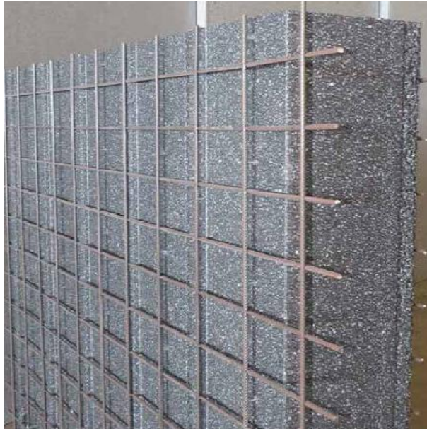
Figura 3.1 – Pannello in EPS con rete elettrosaldata utilizzato per la realizzazione di pannello sandwich prodotto dalla ditta TCS
