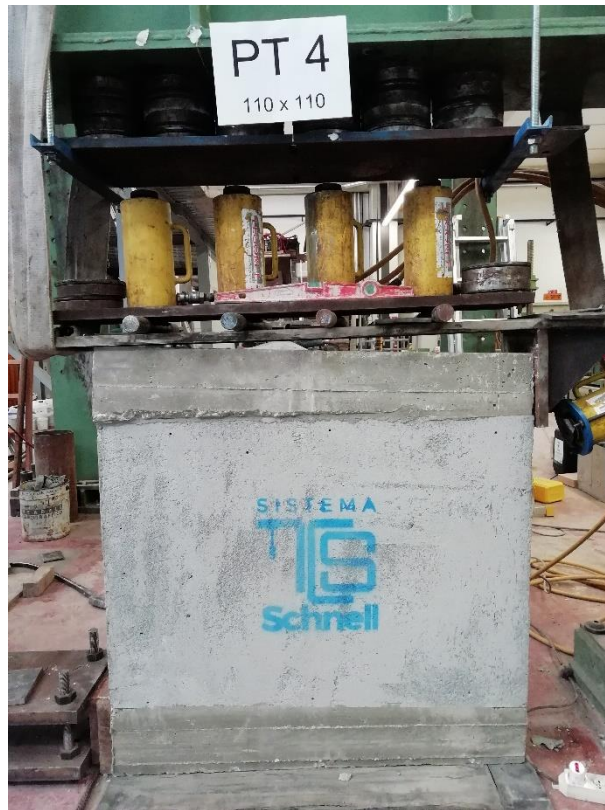
Figura 5.8 – Irregolarità costruttiva provino PT4 con evidente non planarità
