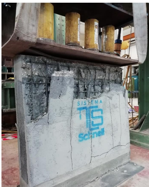
Figura 6.11 - Schiacciamento cordolo superiore provino CC1
