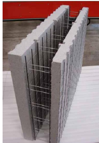
Figura 1.2 – Pannello doppio TCS Schell costituito da due lastre in EPS, avente funzione di cassero a perdere per il successivo getto
