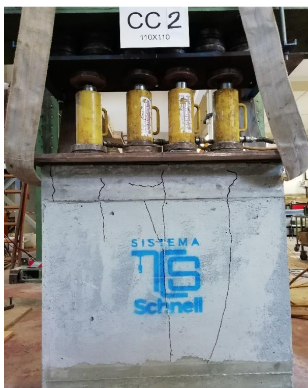
Figura 6.12 - Schiacciamento cordolo superiore e fessurazioni verticali CC2
