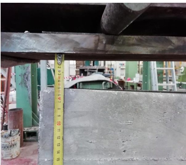
Figura 5.9 e 5.10 – Particolare della mancata orizzontalità del provino misurate in corrispondenza dello spigolo sinistro e destro
