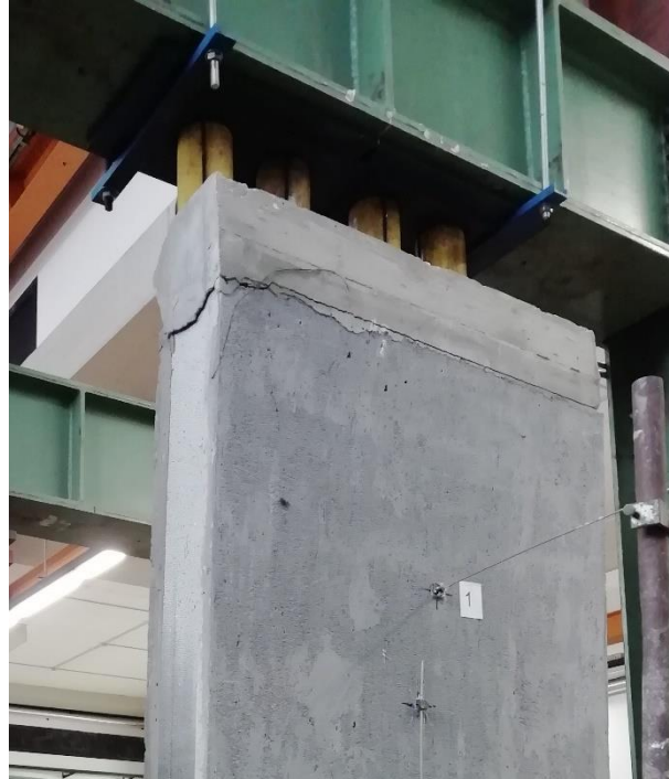
Figura 6.43 - Rotazione cordolo superiore Ce3
