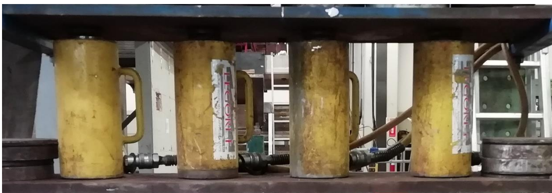
Figura 4.5 – Martinetti piatti utilizzati nelle prove
