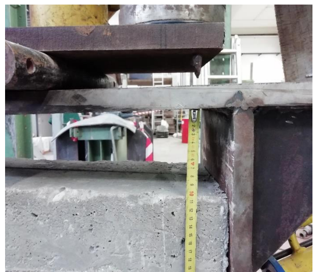
Figura 5.9 e 5.10 – Particolare della mancata orizzontalità del provino misurate in corrispondenza dello spigolo sinistro e destro
