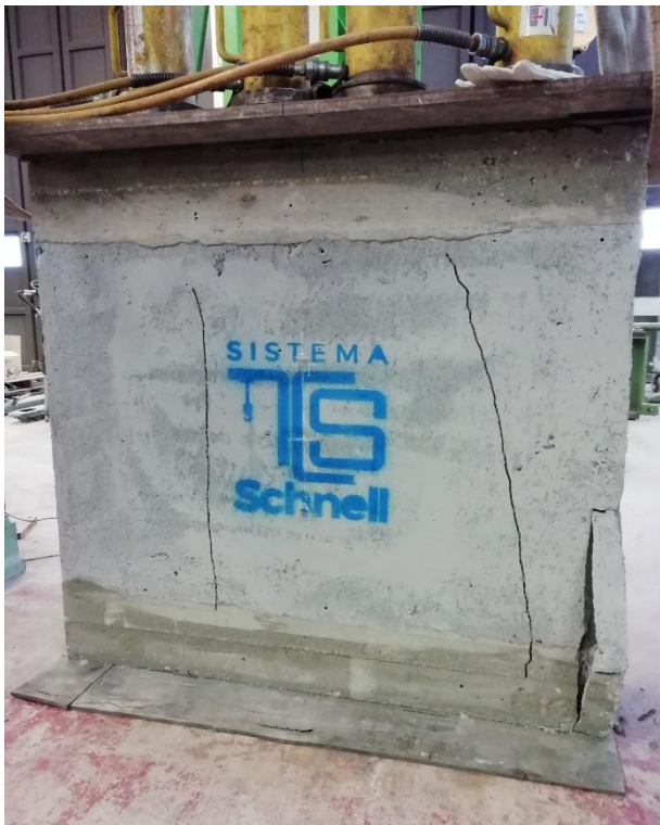
Figura 6.13 - Fessurazione verticale provino CC3
