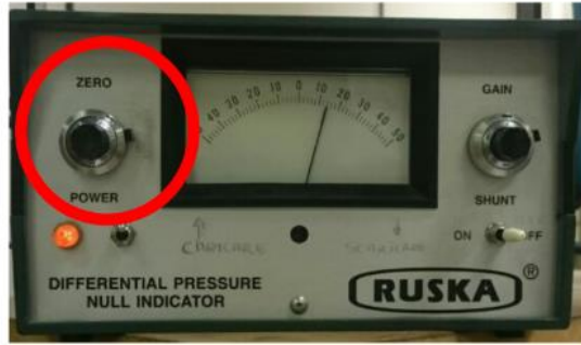
Fig.3.18 Particolare regolazione digit cerchiato in rosso
