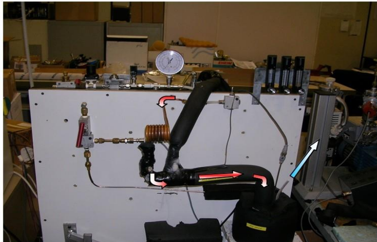
Fig.2.9 Modalità di funzionamento in riscaldamento
