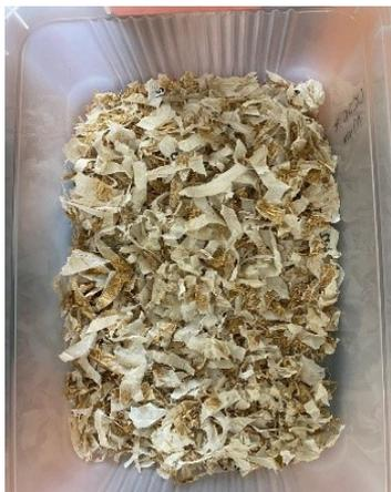
**Figura 2-2: Materiale da testare sminuzzato per la prova di compostaggio.**
