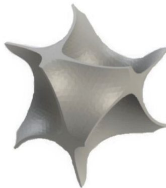
Figura 1.1: Singola cella della struttura Gyroid
