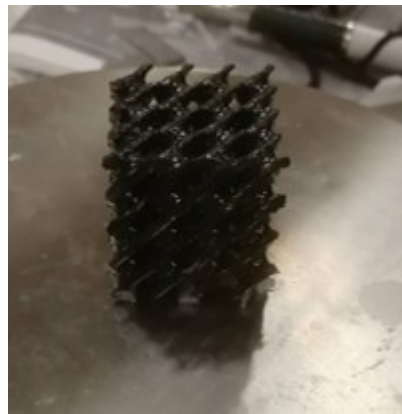
Figura 3.1: Esempio di provino in NylonPA fornito dal Politecnico di Torino ( Diamond 1.6)
